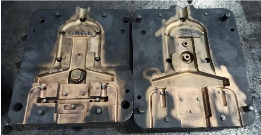
Şekil 3.4 CuCoNiBe kokil kalıbı görseli
