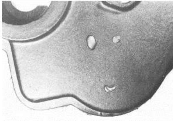
Şekil 2.31 Üst yüzeyde oluşmuş gaz boşluğu hata örneği (Tüdöksan, 2014)
