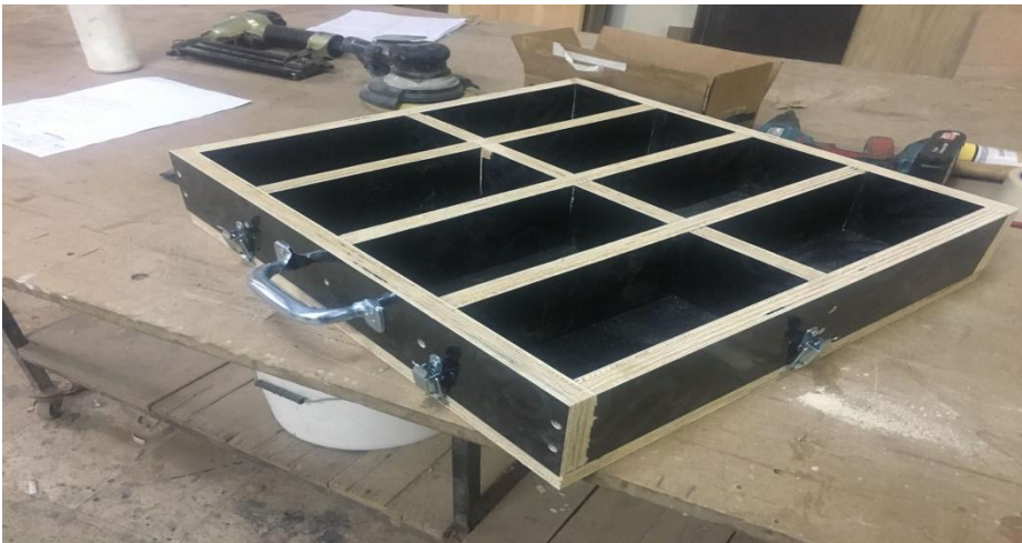
Şekil 16. Parkelerin üretiminde kullanılan kalıp görüntüsü
