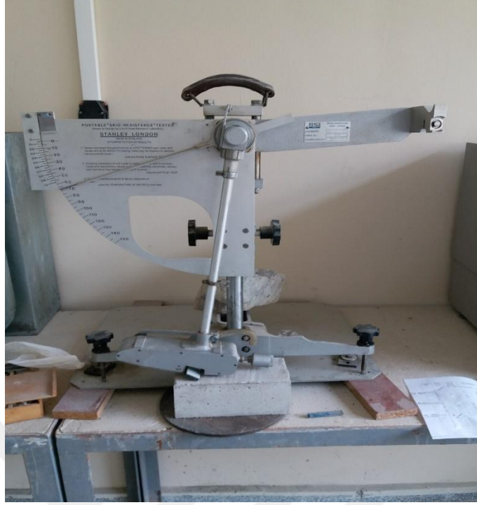
Şekil 28. Sarkaçlı sürtünme deney donanımı
