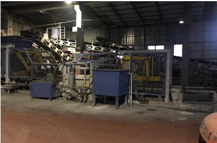
Şekil 5. Beton parke karıştırıcısından kalıba döküm ve çıkış kısmının görüntüsü
