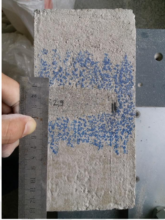
Şekil 27. Dikey aşınma deneyinden sonra parkede ölçülen mesafe görüntüsü
