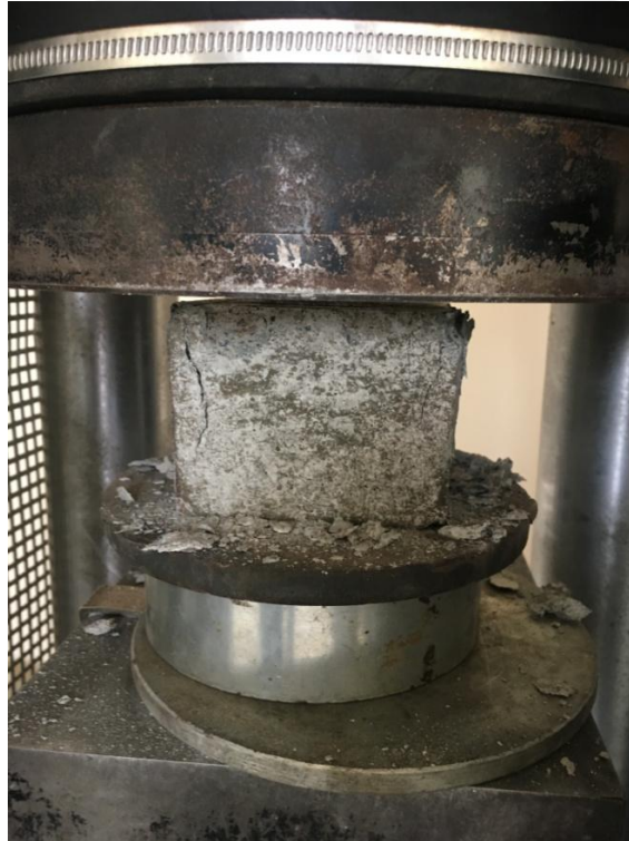
Şekil 25. Basınç dayanım deney düzeneği
