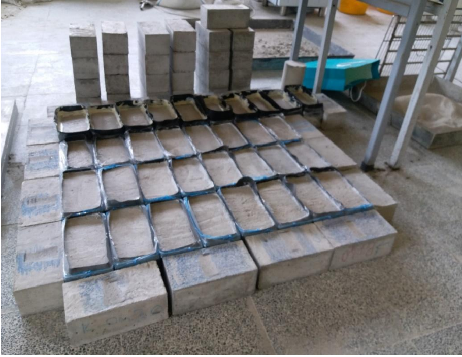
Şekil 21. Beş yüzü yalıtım malzemesiyle kaplanmış parke görüntüsü
