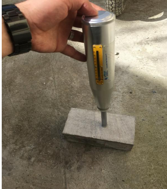
Şekil 29. Shcimitd test çekiciyle parkelerde yüzey sertliği ölçümü
