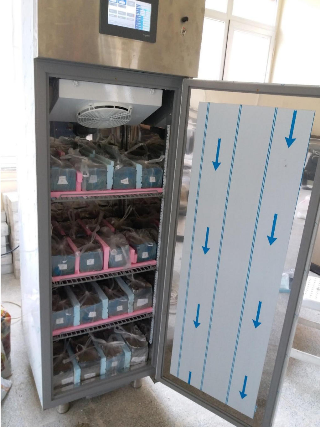
Şekil 22. Havada donma çözülme iklimlendirme kabini
