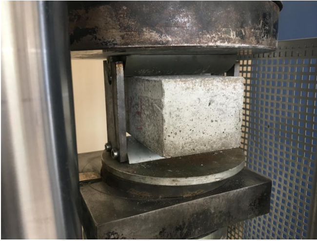
Şekil 24. Yarmada çekme dayanım deney düzeneği
