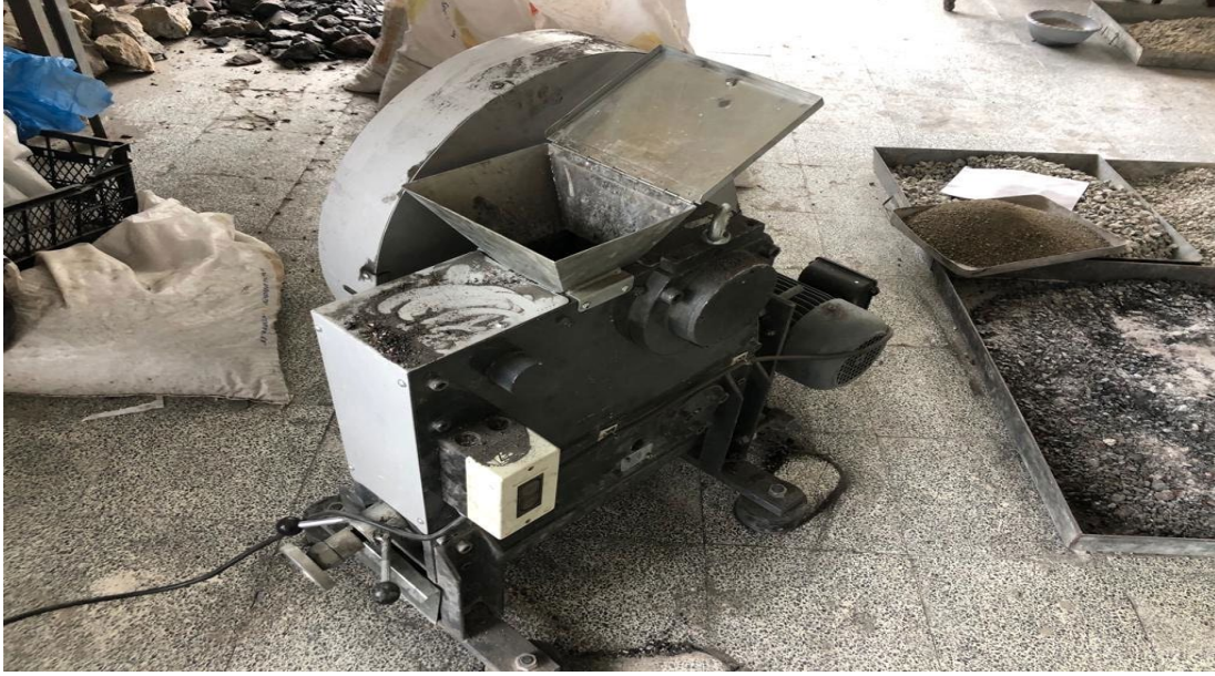
Şekil 11. Çeneli Kırıcıda Piritli Kayaç'ın Öğütülmesi
