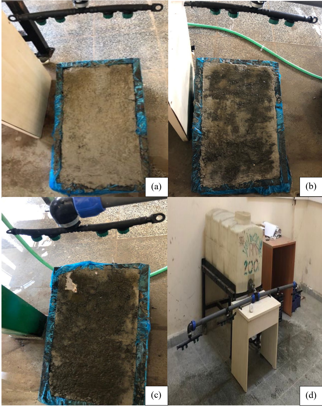
Şekil 22. 50x240x500 mm Numuneler a) Brüt Beton b) 1kg/m 2 Piritli İnce Agrega Uygulanmış Numune c) 3kg/m 2 Piritli İnce Agrega Uygulanmış Numune d) Deney Düzeneği
