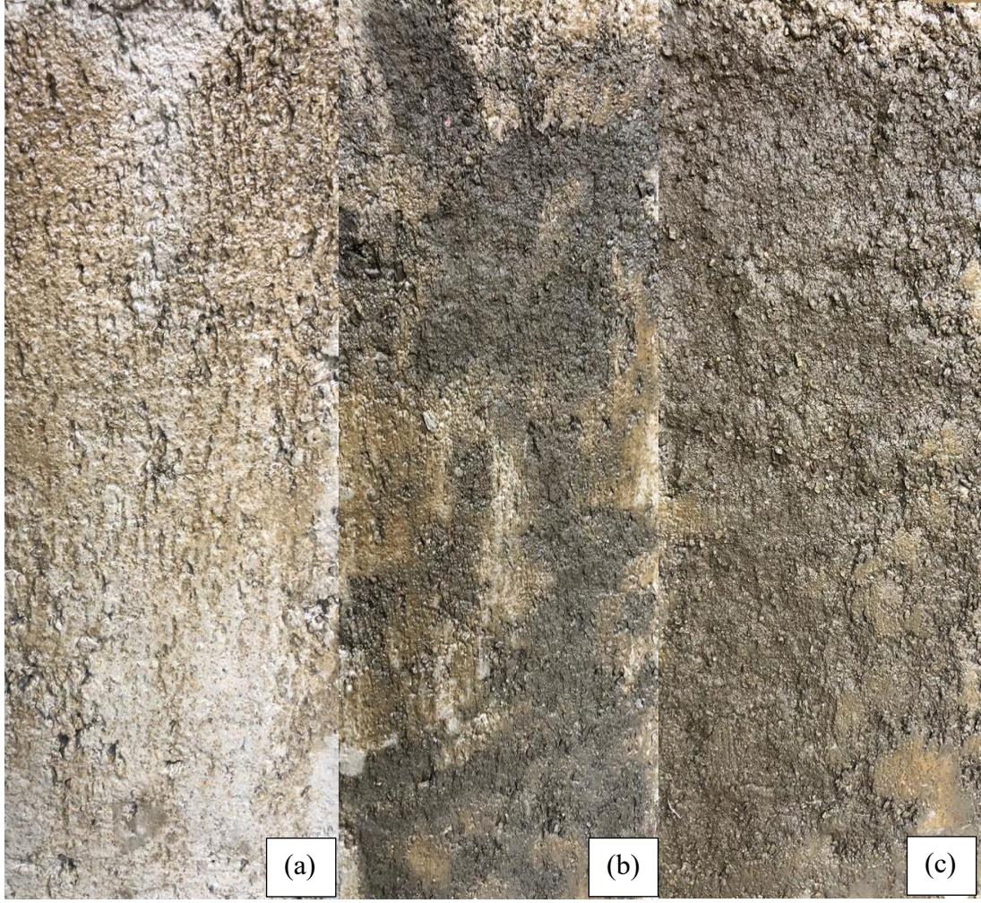
Şekil 23. 50x240x500 mm Numune 2 Aylık Sürecin Sonunda Betondaki Renk Değişimi
