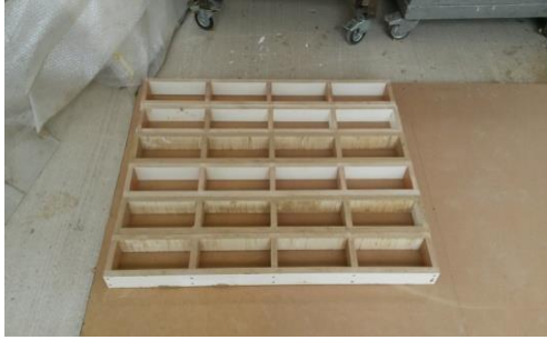
Fotoğraf 5: Kerpiç tuğla üretiminde kullanılan ahşap kalıplar ve basılacak çamur toprakların hazırlanması
