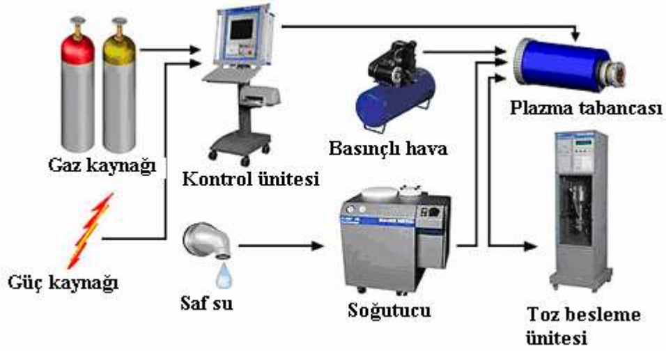
Şekil 2. 2. Plazma sprey yönteminin bileşenleri
