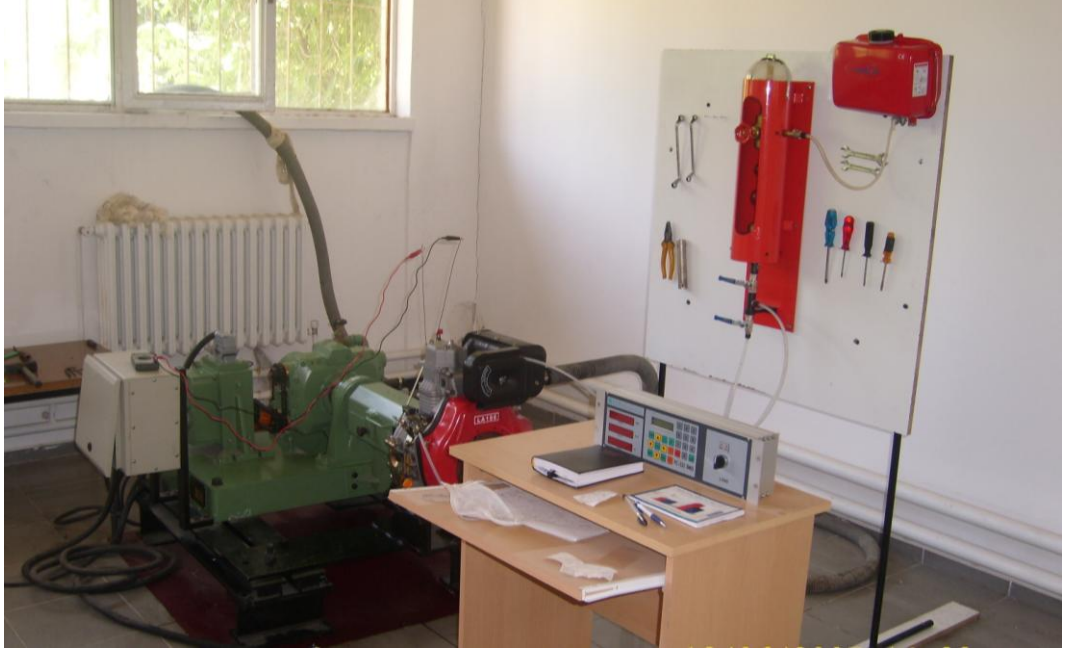
Şekil 4. 4. Deneylerde kullanılan BT-140 model hidrolik dinamometre
