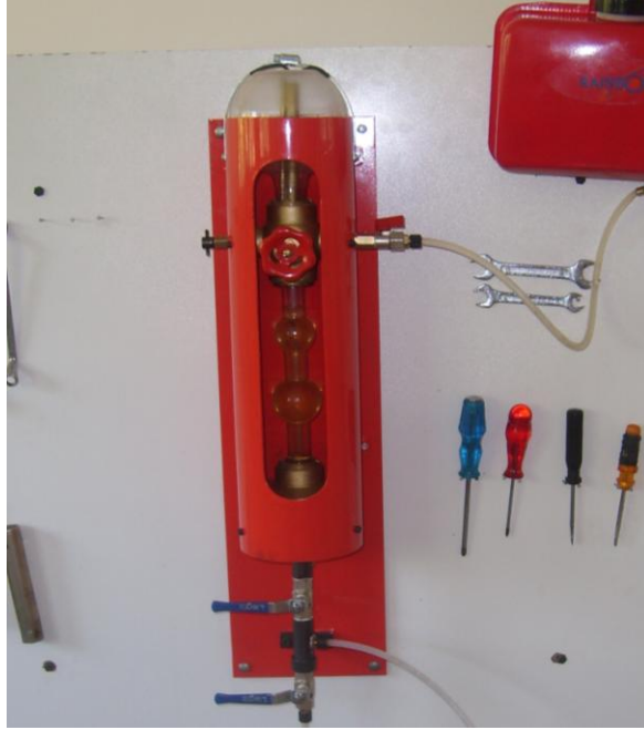
Şekil 4. 5. Yakıt tüketimi ölçüm ünitesi
