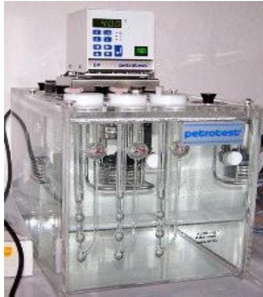
Şekil 3. 7. Viskozite lm cihazı [37]
