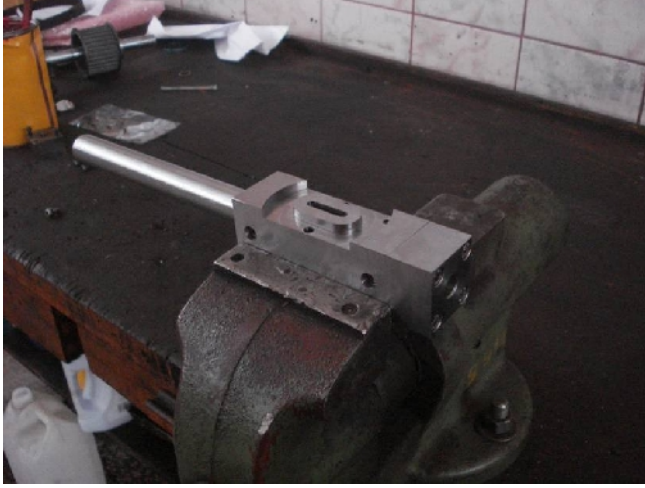
Resim 1.10 Döner supapın montajı
