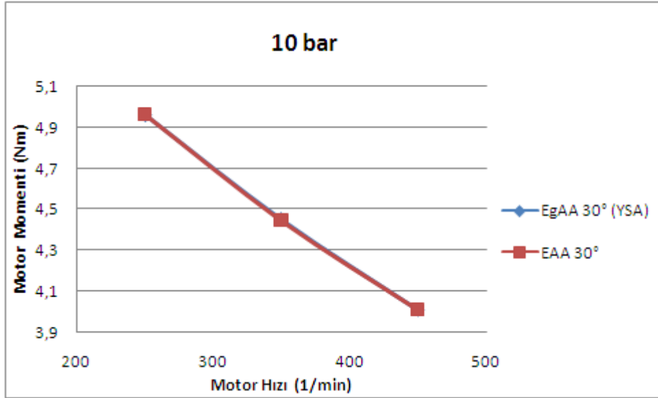
Şekil 7.9. EgAA 30° Supap Zamanlaması, 10 bar Çalışma Basıncı, Farklı Motor Hızlarına Ait Gerçek ve YSA'lı Motor Momenti-Motor Hızı Grafiği
