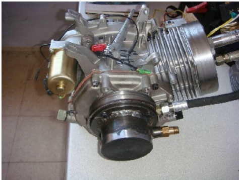
Resim 4.3. Hava distribütörü kullanarak tahrik edilecek basınçlı hava motoru
