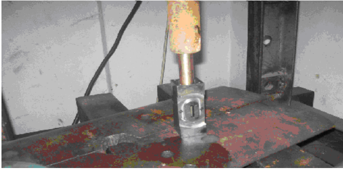
Resim 1.6. Bronz yatak malzemesinin gövdeye preslenmesi
