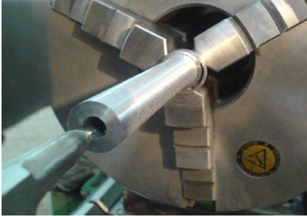
Resim 1.4. Döner supap milinin metal çapaklarının alınması
