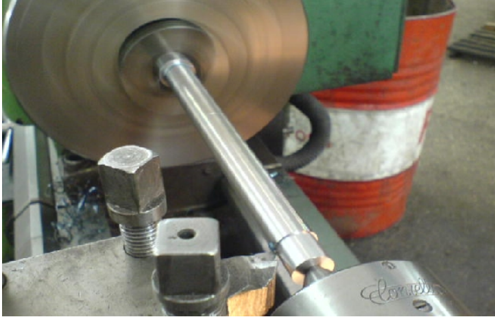
Resim 1.2. Ham malzemenin dış yüzeyinin işlenmesi
