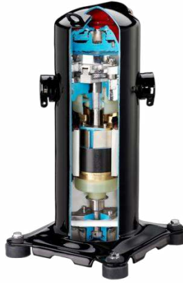
Şekil 1.5. Scrol kompresörün kesit hali.
