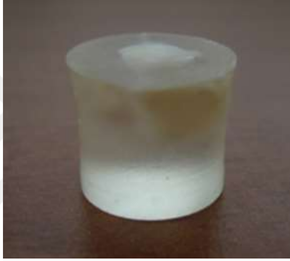
Resim 20: Akril bloğa gömülmüş ve mine yüzeyi açığa çıkarılmış bir örnek
