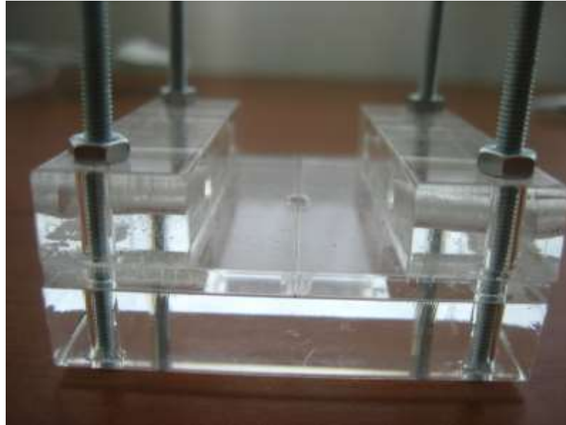
Resim 24: Pleksiglass kalıbın diğer üst parçasının yerleştirilmiş hali
