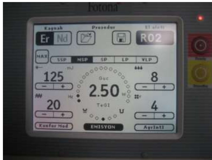
Resim 3: Lazer cihazında pürüzlendirme parametreleri
