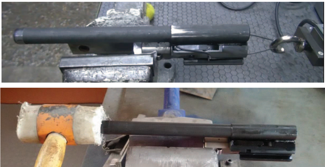
Şekil 4.8. G3 piyade tüfeğinin gaz piston sistemi ile açılabilceğinin gösterilmesi
