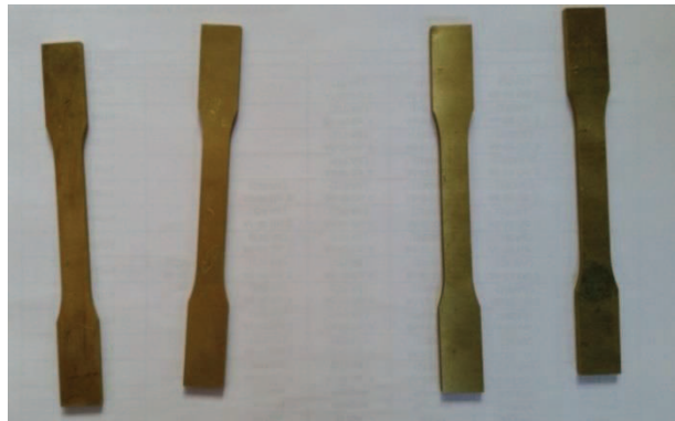
Şekil 3.4. Yüksük şeridinden hazırlanan pirinç çekme testi numuneleri
