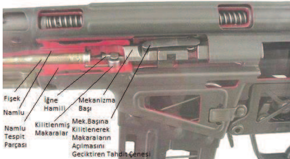
Şekil 4.4. G3 piyade tüfeğinin mekanizma kilitli haldeki kesit resmi [28]
