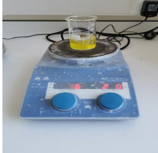
Şekil 3.2 Örnekten dietil eterin uçurulması
