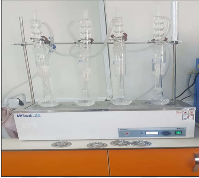
Şekil 2.2. Helva numunelerinden yağ ekstraksiyon işlemi
