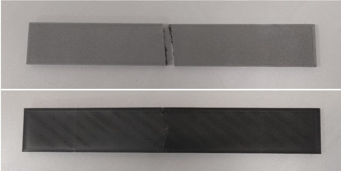
Şekil 4.18. PLA (üst) ve ABS (alt) test numunelerin üç nokta eğme deneyi sonrası örnek numune görseli
