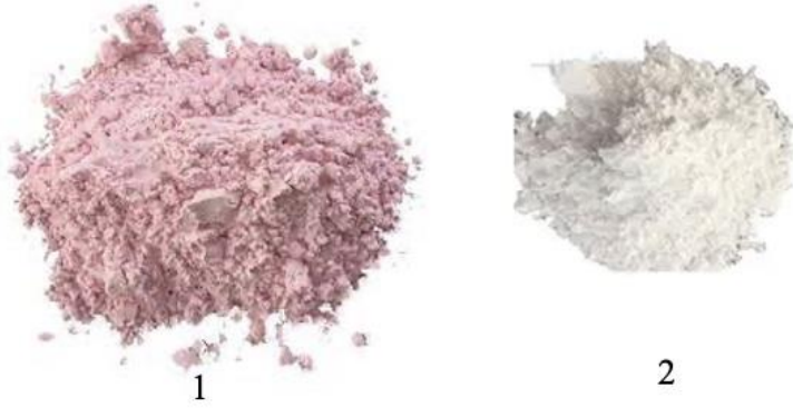
Şekil 3.5 1) \text{Er}_2\text{O}_3 ve 2) \text{Gd}_2\text{O}_3 nano boyutta metal tozu
