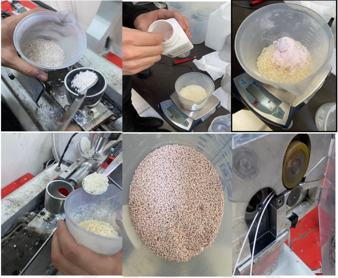
Şekil 3.7 Filamentlerin üretim aşamaları
