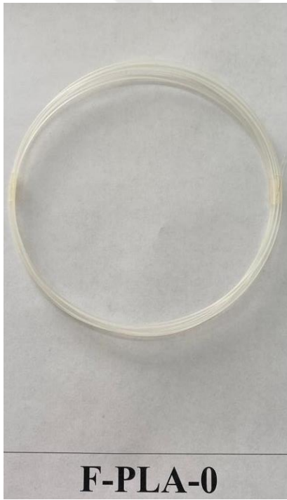
Şekil 3.3 Üretimi gerçekleştirilen saf PLA filamenti
