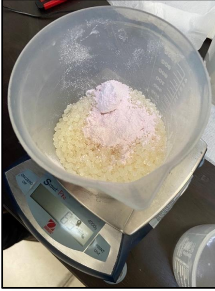
Şekil 3.4 PLA granülleri ve nano boyuttaki \text{Er}_2\text{O}_3 tartımı
