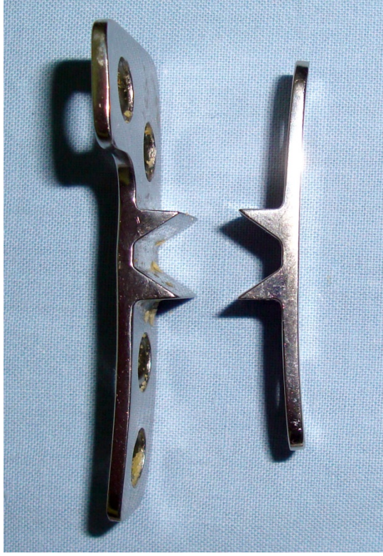
Şekil 5.30. Mekanik deney sonucu E grubu plaklar.
