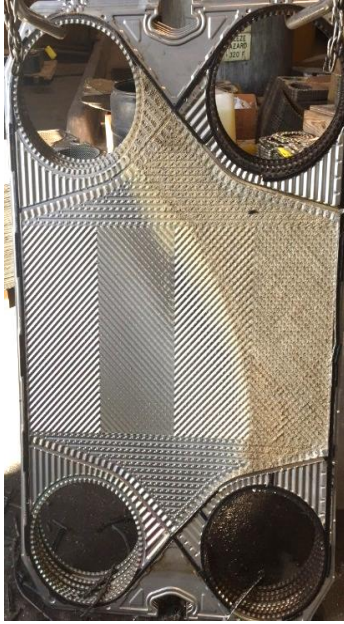
Resim 7.5. Akışkanı iyi yönlendirilemeyen plaka
