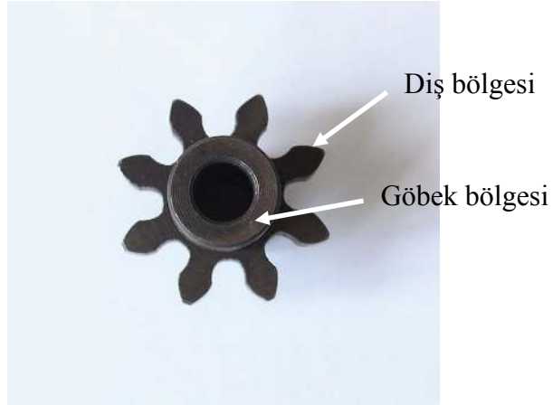
Şekil 5.1. Deneysel çalışmalarda kullanılan dişli numune.
