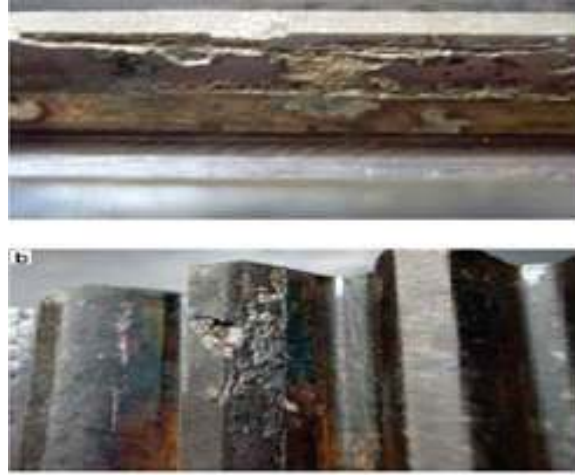
Şeki 2.11. Güneş dişlisinde meydana gelen pitting hataları.
