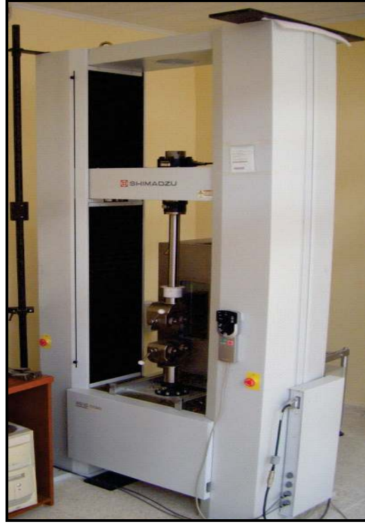
Şekil 5.3. Shimadzu AG-X marka universal test cihazı.
