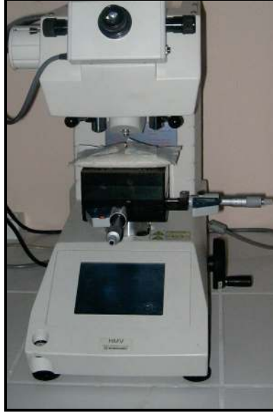
Şekil 5.2. Shimadzu mikrosertlik ölçüm cihazı.
