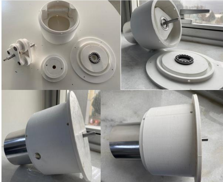
Şekil 3.68. Planet redüktör kutusu ve motor entegrasyonu
