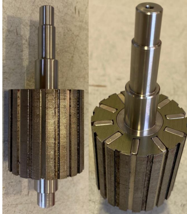
Şekil 3.56. Rotor paketine sıkı geçirilmiş rotor mili
