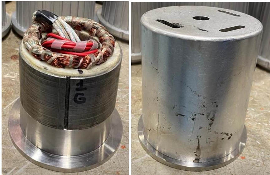
Şekil 3.70. Statorun motor gövdesine geçirilmesi
