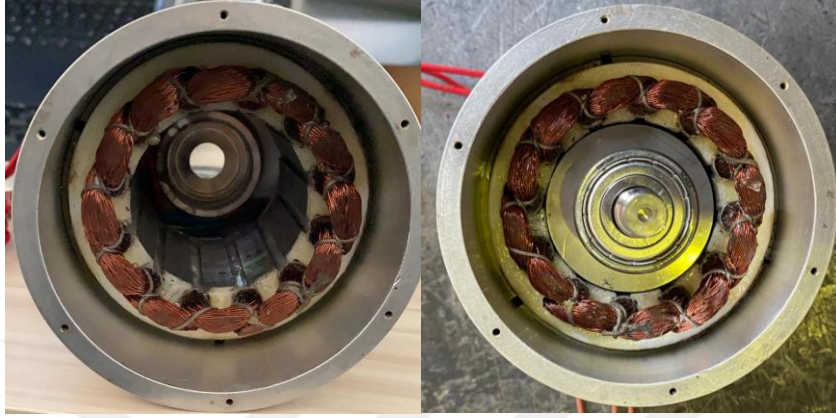
Şekil 3.71. Rotorun gövdeye geçirilmesi ve sargıların son hali
