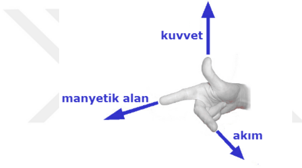
Şekil 3.4. Sağ el kuralı ile manyetik kuvvetin gösterimi (Gieras, 2017)
