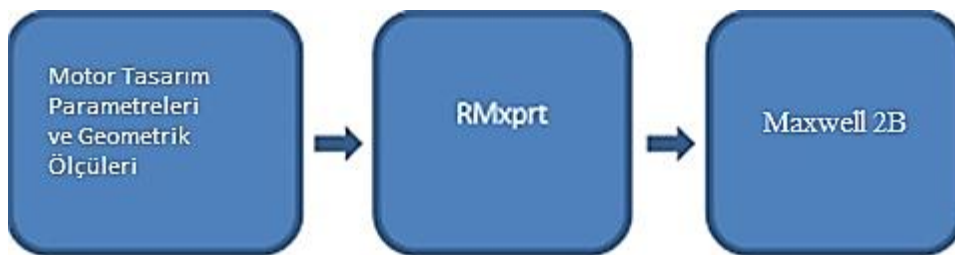
Şekil 3.77. Maxwell analiz akış diyagramı
