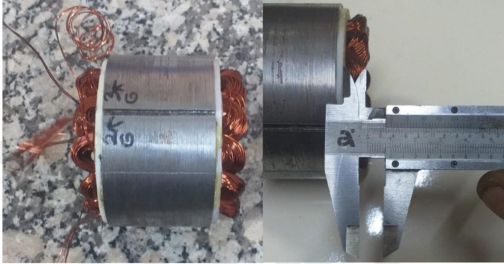
Şekil 3.49. Sarım şemasına göre sargıları yapılmış stator ve uç uzantı ölçümü
