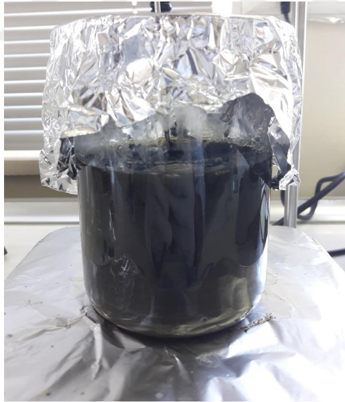
Şekil 3.2. Demir nanopartikül (SOE@FeNP) sentezi.
