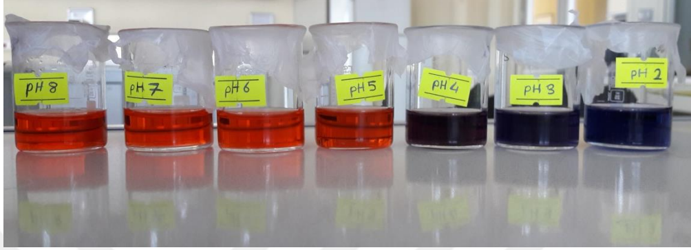
Şekil 3.5. Kongo kırmızısının pH 2-8 arasında çözeltilerinin hazırlanması.
