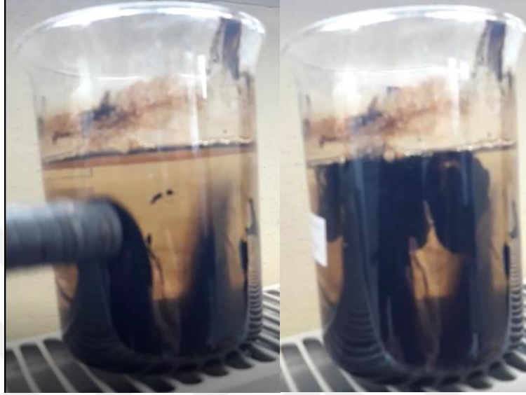
Şekil 3.3. Nanopartikül süpermanyetik oluşumunun test edilmesi.
