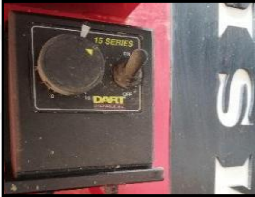
Şekil 35. Jigin frekans ayar düğmesi
