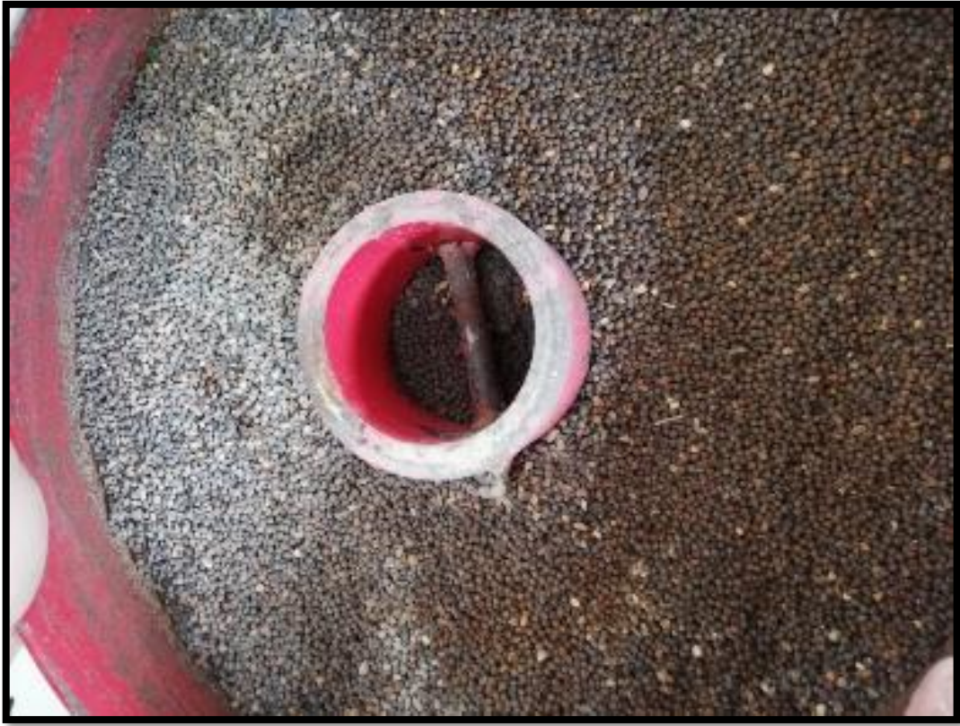
Şekil 36. Bilya yatağı kalınlaştırılan sol jig
