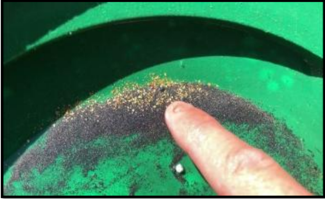
Şekil 5. Yıkama tavaasında zenginleştirme
