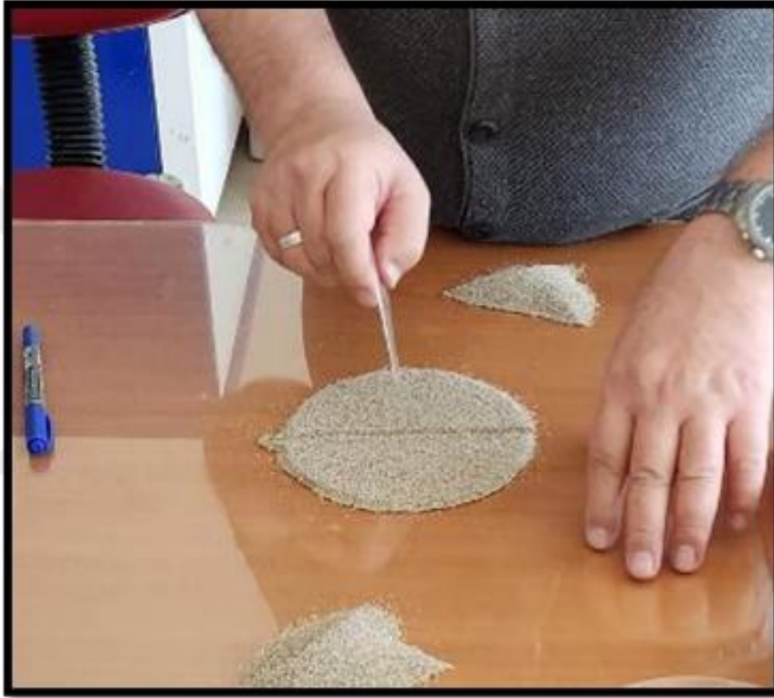
Şekil 28. Konileme dörtlleme yöntemi ile numune azaltma işlemi
