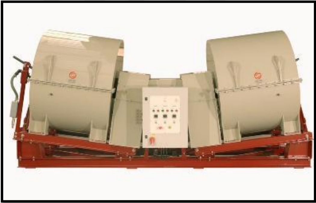
Şekil 16. Mutli gravite seperatör (MGS) şematik gösterimi
