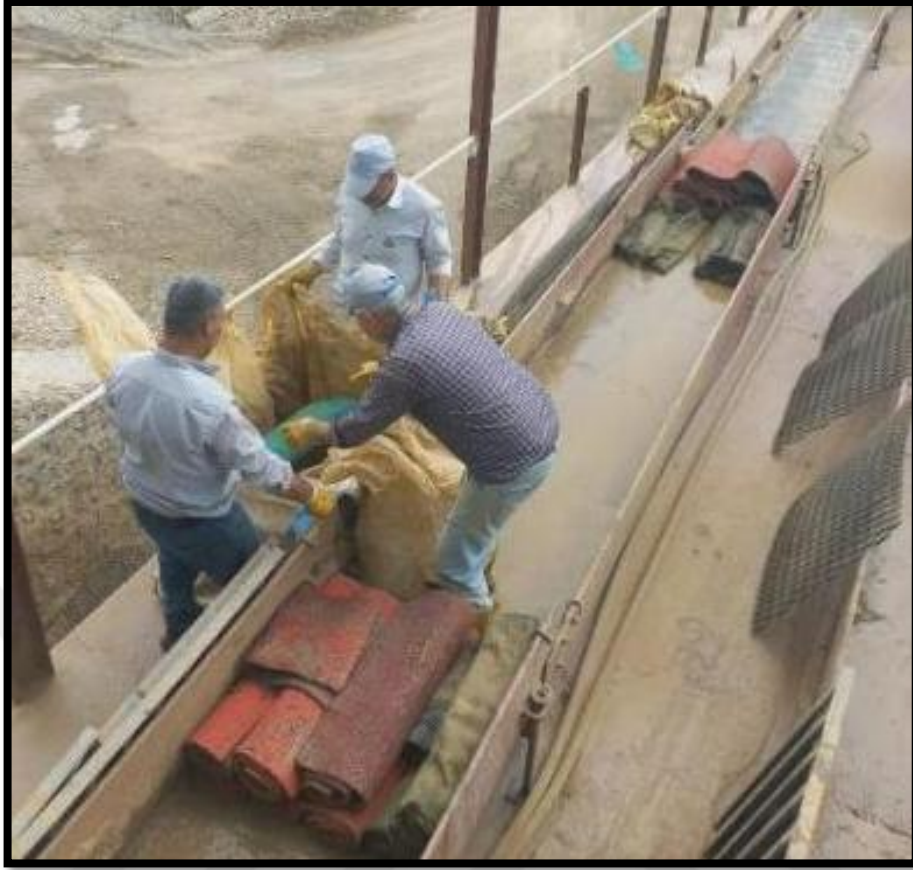
Şekil 22. Oluklara halı serilme işlemi
