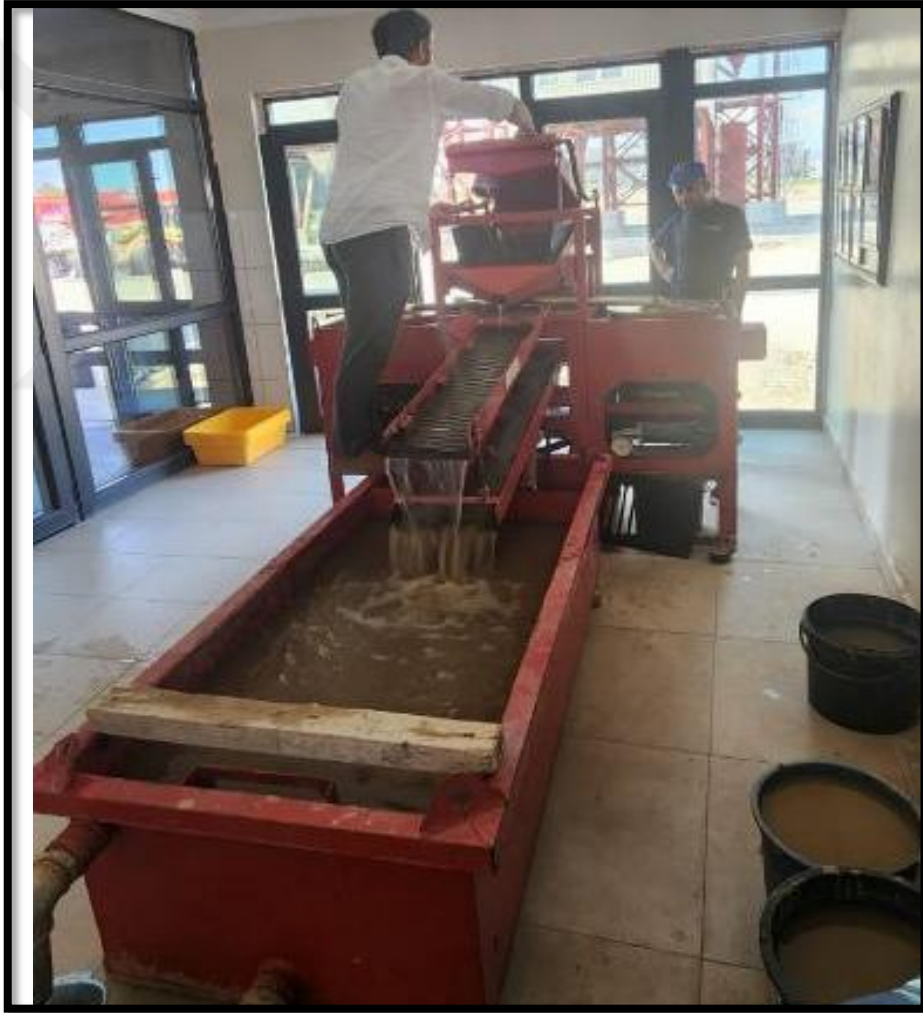
Şekil 34. Tesiste bulunan jig ve deneylerde kullanılan jig (Enhancer 755)
