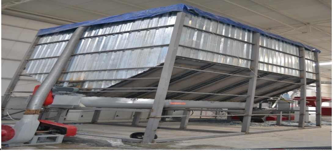
Şekil 4.7. Plastik geri kazanım hattı – çapak deposu ünitesi [7].
