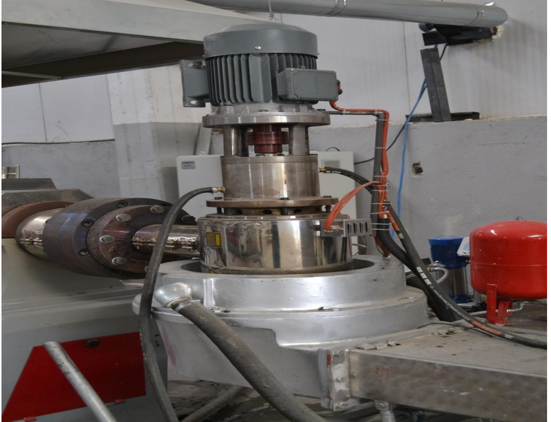
Şekil 4.11. Plastik geri kazanım hattı – granül kesim ünitesi [7].
