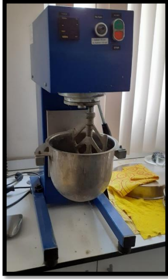
Şekil 3.7. Harç karışımların üretilmesinde kullanılan mikser
