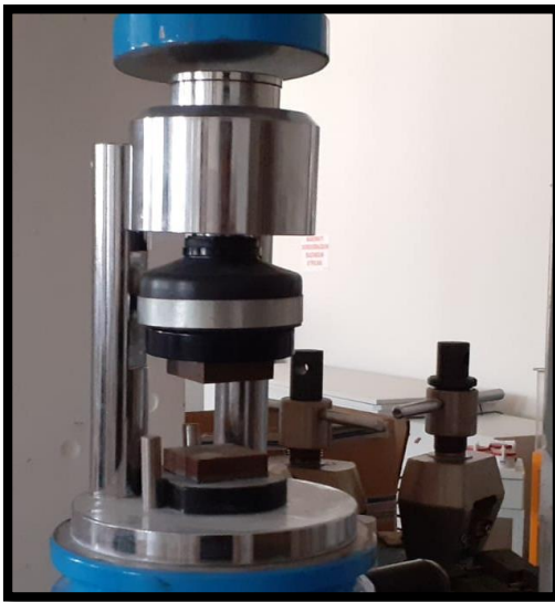
Şekil 3.13. Basınç dayanımı tayininde kullanılan yükleme çerçevesi
