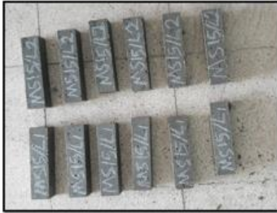
Şekil 3.8. Harçların kalıptan çıkarılması ve kür tankına konulması
