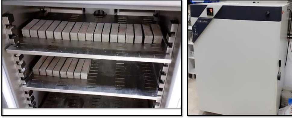
Şekil 3.11. Numunelerin etüve konulması
