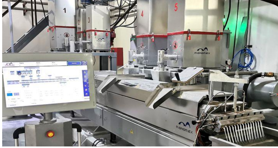
Şekil 2-1 Monomex Besleme Sistemi [10]
