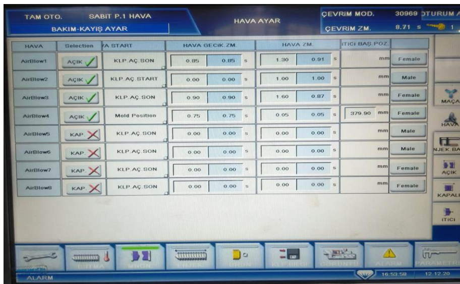
Resim 2.6. Zhafir plastik enjeksiyon makinesi hava kontrol sayfası
