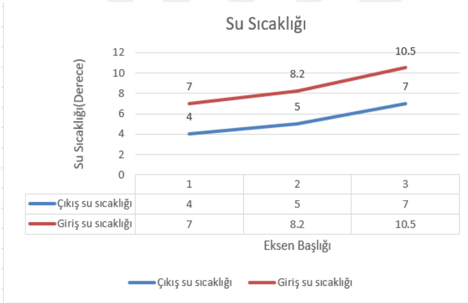
Şekil 2.2. Chiller soğutma sistemi su giriş-çıkış sıcaklık grafiği
