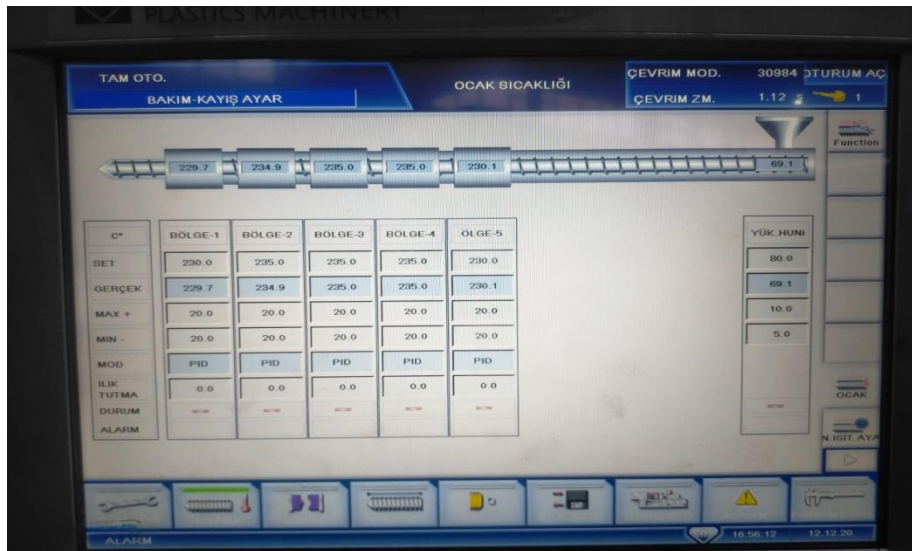
Resim 2.1. Zhafer plastik enjeksiyon makinesi ocak ısı kontrol sayfası
