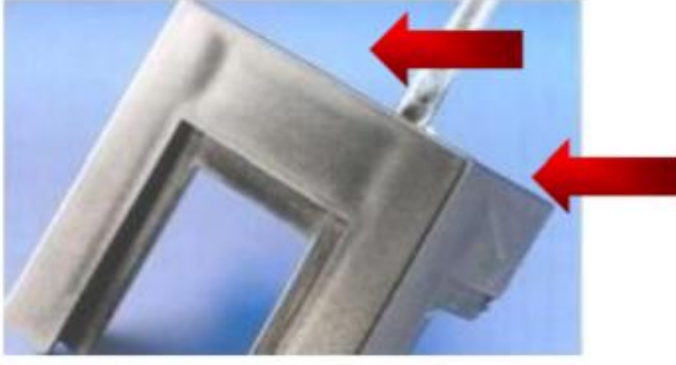
Resim 3.6. Parça yüzeyindeki çöküntü
