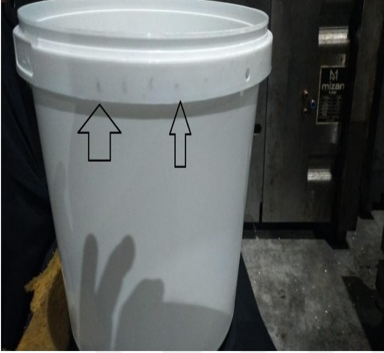
Resim 3.1. Yanık izi oluşan parça
