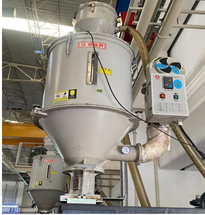
Şekil 3.3. Plastik enjeksiyon hunisi (silo)
