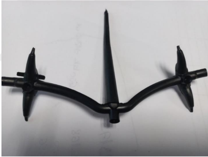
Şekil 3.8. Örnek yolluk şekli (muz tipi yolluk-soğuk yolluk)
