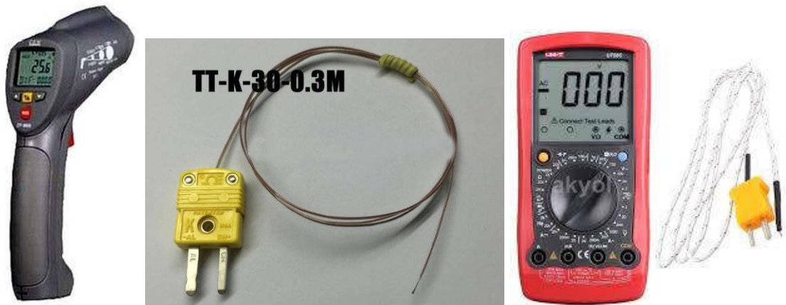
Resim 4.5. Deneyde kullanılan kızılötesi termometre ve termokupl- multimetre
