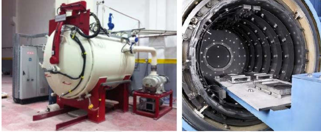
Resim 3.1. Sert lehimleme işlemi için atmosfer kontrollü ısıtıl işlem fırını [119]
