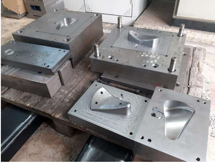
Resim 4.4. Çekirdeklerin kalıba montaj edilmiş hali
