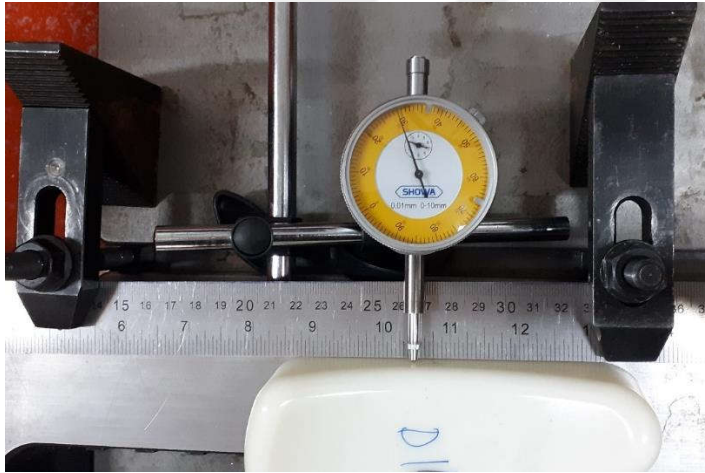
Resim 4.6. Plastik parça üzerindeki çarpılmanın ölçülmesi
