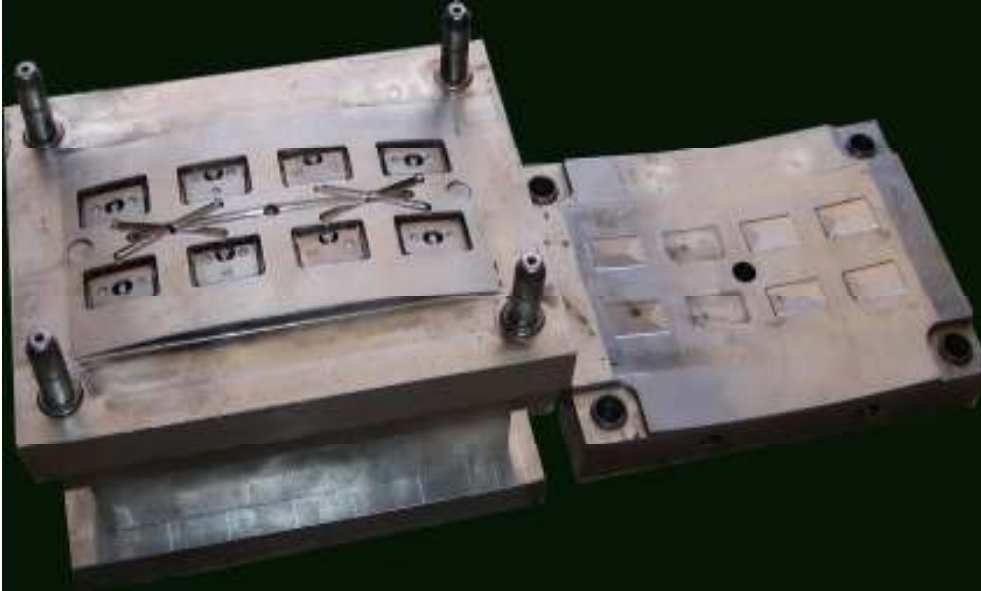
Şekil 5.15. Otobüs ikaz düğme kalıbının açılmış haldeki iç görünüşü
