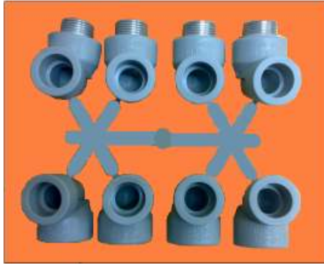
Şekil 5.11. \frac{3}{4} inch plastik dişli dirsek baskı numunesi
