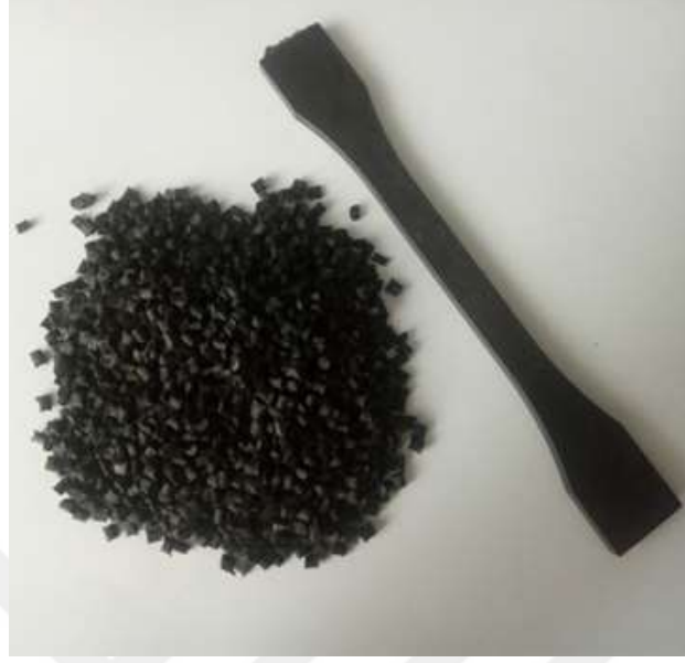
Şekil 3.2 Plastik enjeksiyon işleminde kullanılan cam takviyeli PA granülleri ve çekme test numunesi [68]
