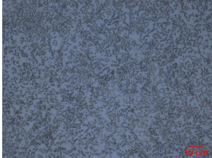
Şekil 7.1 1.2842 çeliğinin 50X objektif metal mikroskopta alınan görüntüsü (Hafif dağlanmış)
