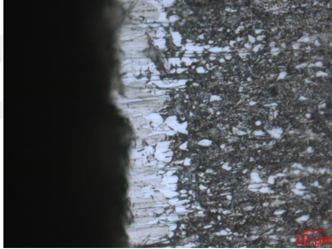
Şekil 7.24 1.2842 çeliğinin 850°C, 4 saat sürede uygulanan kutu borlama işlemi sonucunda elde edilen bor tabakasının 50X objektif büyütmede metal mikroskobundan elde edilen iç yapı görüntüsü
