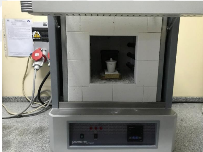
Şekil 6.7 Kutu borlama işleminde kullanılan fırın ve numunelerin konumları (Kişisel arşiv, 2020)
