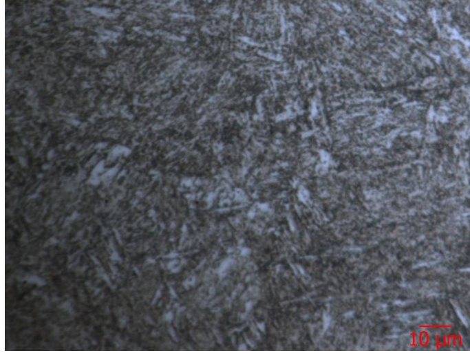
Şekil 7.19 I1 çeliğinin 50X objektif metal mikroskopta alınan görüntüsü (Yoğun dağlanmış)
