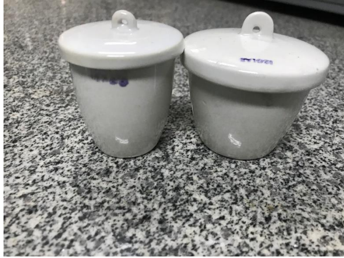
Şekil 6.6 Kutu borlama işleminde kullanılan alümina kroze kapları (Kişisel arşiv, 2020)
