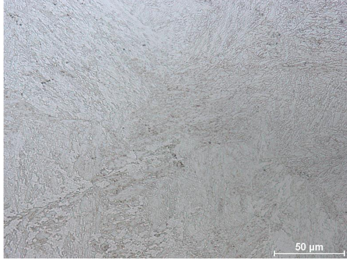
Şekil 7.14 N1 çeliğinin 50X objektif optik mikroskopta alınan görüntüsü (Hafif dağlanmış)
