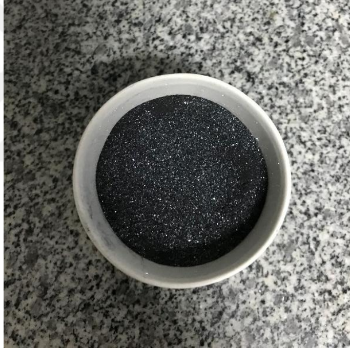
Şekil 6.5 Alümina seramik pota içerisinde Ekabor-2 ve Ekrit tozuyla kaplanan numune (Kişisel arşiv, 2020)
