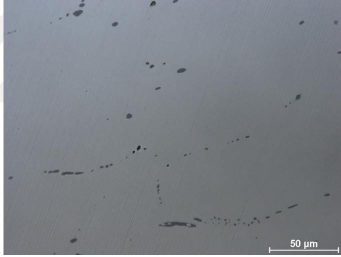
Şekil 7.6 R1 çeliğinin 50X objektif optik mikroskopta alınan görüntüsü (Hafif dağlanmış)
