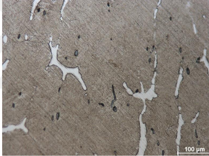
Şekil 7.8 R1 çeliğinin 50X objektif optik mikroskopta alınan görüntüsü (Yoğun dağlanmış)
