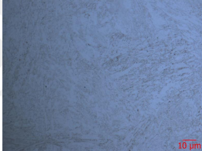
Şekil 7.13 N1 çeliğinin 50X objektif metal mikroskopta alınan görüntüsü (Hafif dağlanmış)
