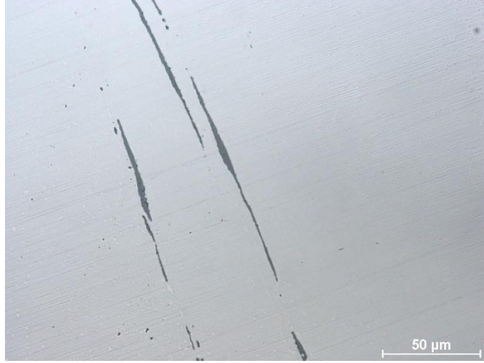
Şekil 7.10 C1 çeliğinin 50X objektif optik mikroskopta alınan görüntüsü (Hafif dağlanmış)
