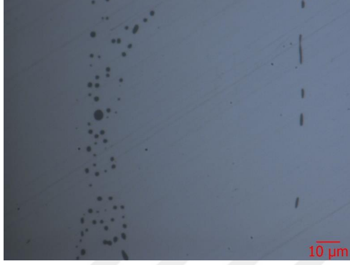
Şekil 7.5 R1 çeliğinin 50X objektif metal mikroskopta alınan görüntüsü (Hafif dağlanmış)
