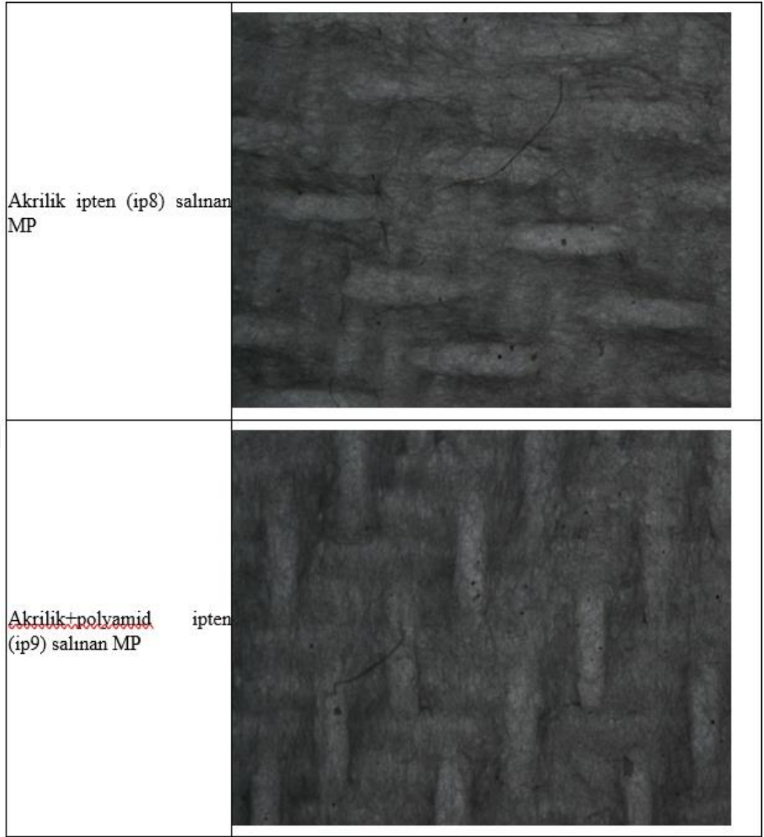
Şekil 4.5. Yaşlandırma - MP salım incelemelerinde optik mikroskop görüntüleri
