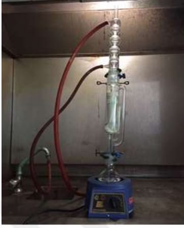
Şekil 3.5. Çalışmada kullanılan Sokslet ekstraksiyonu deney düzeneği
