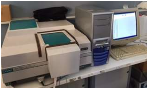
Şekil 3.13. Çalışmada kullanılan UV-Vis spektrofotometre cihazı
