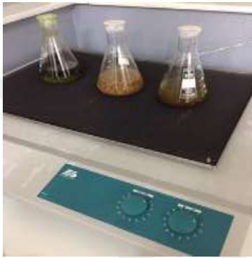
Şekil 3.3. Çalışmada kullanılan çalkalayıcı
