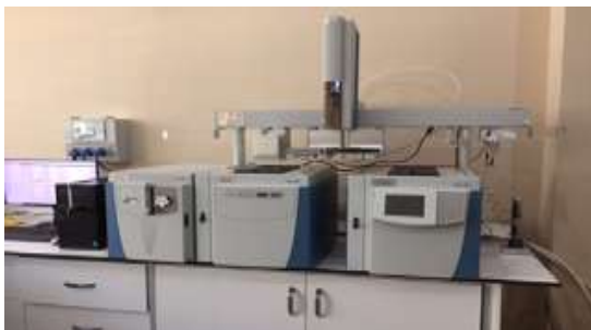
Şekil 3.10. Çalışmada kullanılan GC-MS cihazı
