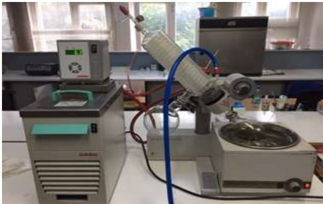
Şekil 3.2. Çalışmada kullanılan rotary evaporatör ve soğutmalı sirkülör
