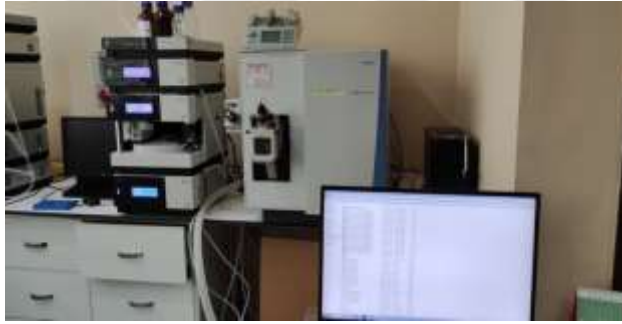
Şekil 3.9. Çalışmada kullanılan U-HPLC-MS/MS cihazı
