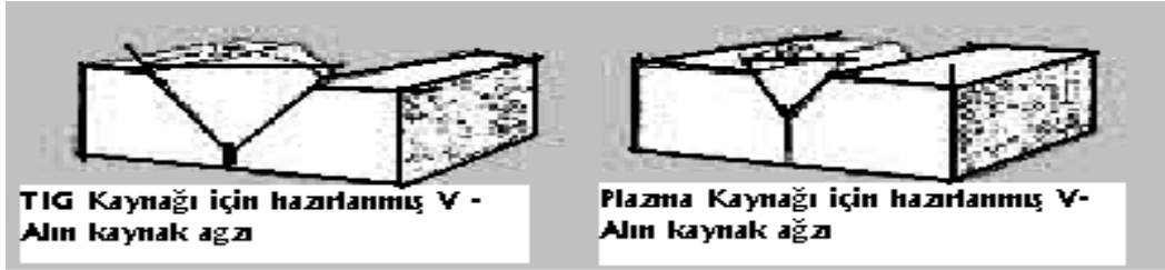
Şekil 2.2. TIG Kaynak Yöntemi ve Plazma Kaynak Ağız Şekilleri (KALUÇ,2008)
