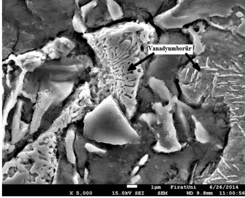
Şekil 4.12. Fe-V+ Fe-B içeren numunelere ait 5000X büyütmeli SEM fotoğrafları (a) N6, b) N8 ve c) N10)
