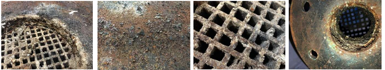
Şekil 14. Kül eriyiğinin ızgara ve reaktör tabanına yapışmış hali
