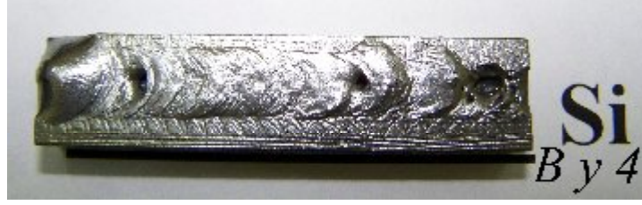
Şekil 7.54 Saf Ar + % 1 N 2 atmosferinde silisyum kaplanan numunenin fotoğrafı
