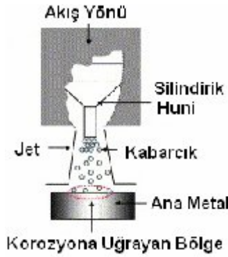
Şekil 3.13 Kavitasyon aşınma mekanizması
