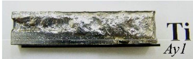
Şekil 7.8. Saf Ar atmosferinde titanyum kaplanan numunenin fotoğrafı
