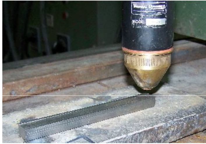
Şekil 7.2. Uygun amper ayarı belirlemek için kaynak dikişi işleminin dijital fotoğrafı
