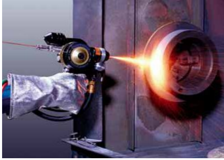
Şekil 2.15 Tel püskürtmeli plazma spreyleme
