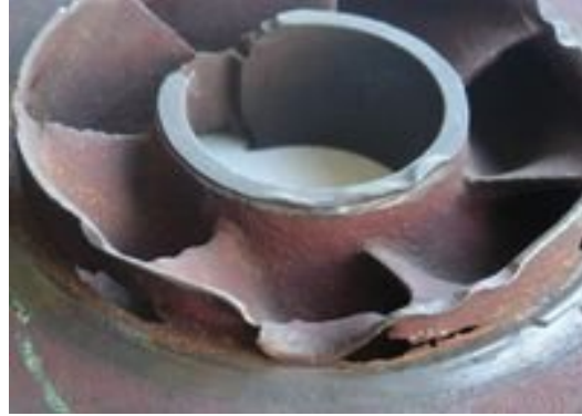
Şekil 3.14 Kavitasyon aşınmasına uğramış pompa
