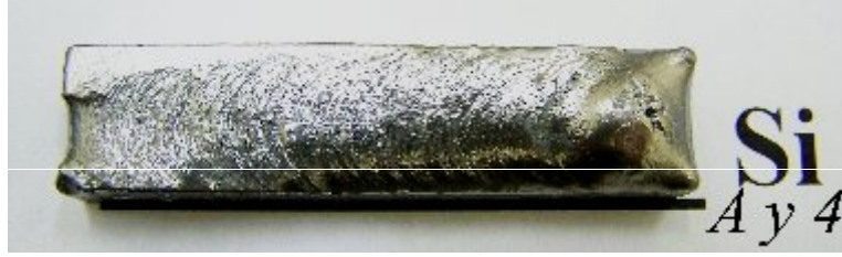
řekil 7.50 Saf Ar atmosferinde silisyum kaplanan numunenin fotoğrafı
