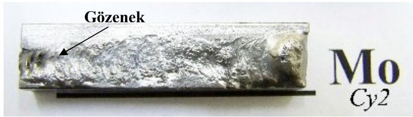
Şekil 7.29 Saf Ar + % 3 \text{N}_2 atmosferinde ferromolibden kaplanan numunenin fotoğrafı
