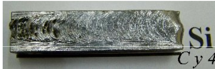
Şekil 7.57 Saf Ar + % 3 N 2 atmosferinde silisyum kaplanan numunenin fotoğrafı
