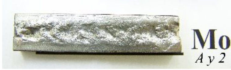
Şekil 7.22. Saf Ar atmosferinde ferromolibden kaplanan numunenin fotoğrafı
