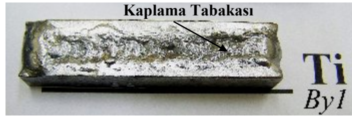
Şekil 7.12. Saf Ar + % 1 N 2 atmosferinde titanyum kaplanan numunenin fotoğrafı
