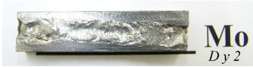
Şekil 7.32 Saf Ar + % 5 N 2 atmosferinde ferromolibden kaplanan numunenin fotoğrafı
