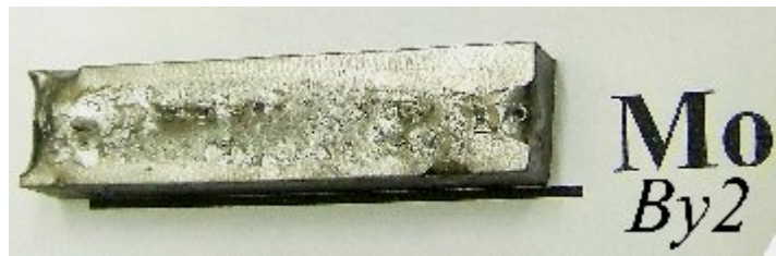
Şekil 7.26 Saf Ar + % 1 N 2 Atmosferinde ferromolibden kaplanan numunenin fotoğrafı
