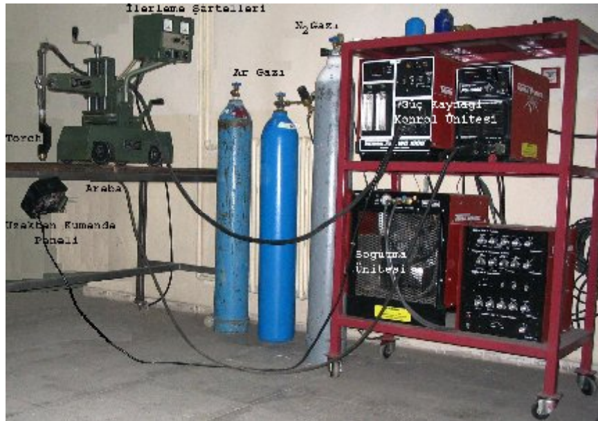
Şekil 6.7. Thermal Dynamic/Ark Plazma Transfer Ark (PTA) kaynak makinesinin tüp bağlantıları ve kontrol panosu
