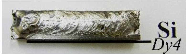
Şekil 7.60 Saf Ar + % 5 N 2 atmosferinde silisyum kaplanan numunenin fotoğrafı
