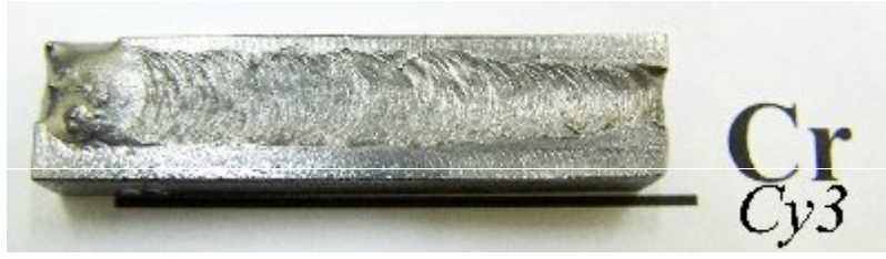
Şekil 7.43 Saf Ar + % 3 \text{N}_2 atmosferinde ferrokrom kaplanan numunenin fotoğrafı
