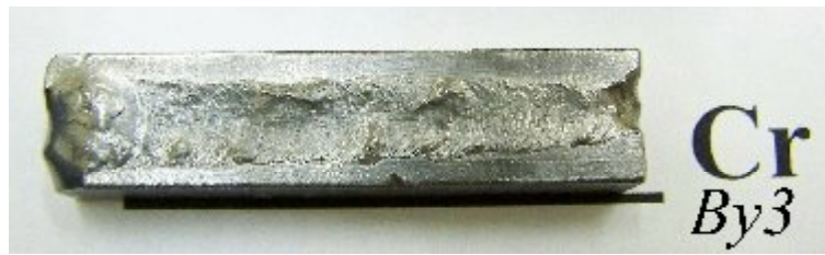
Şekil 7.40 Saf Ar + % 1 N 2 atmosferinde ferrokrom kaplanan numunenin fotoğrafı
