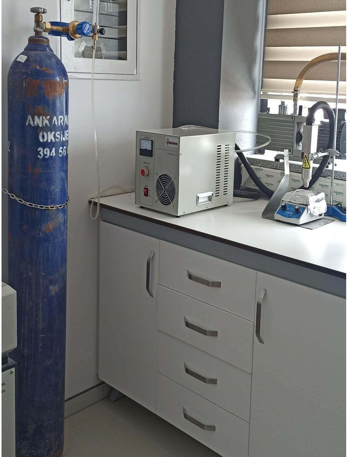
EK-11 Atmosferik Basınçlı Plazma Sistemi deney düzeneği.
