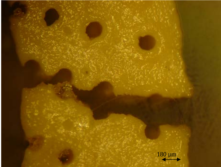
Şekil 7.20 4 tabakalı kompozit kaplama 1300°C sıcaklıktan suya atılarak yapılan termal şok deneyinde 5. döngüden sonra oluşan çatlakların kırılmaya neden olduğu ve Mo fiberin oksitlenerek yüzeyden uzaklaştığı görünüyor
