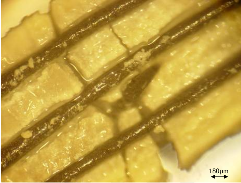
Şekil 7.21 4 tabakalı kompozit kaplama, (1300°C sıcaklıktan suya daldırılarak yapılan termal şok deneyinde 5. döngüden sonra matris kırılarak içerideki fiberlerden alınan görüntü).
