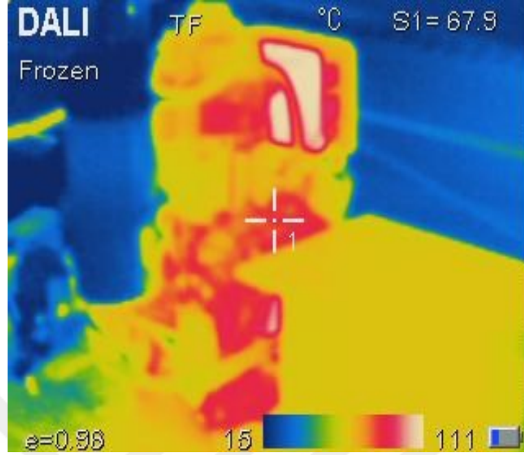
Şekil 6.29. Kaplanmış diesel motorda %100 aspir yakıtının kullanıldığı termal görüntü
