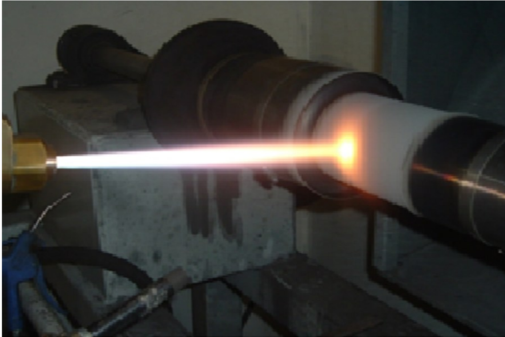
Şekil 2.5. HVOF yöntemi ile yapılan kaplama işlemi
