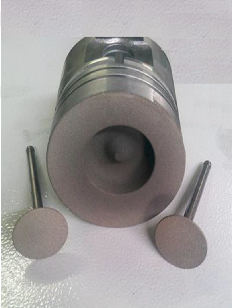
Şekil 5.6. Dizel motorun kaplama yapılan piston ve supaplarının görünümü
