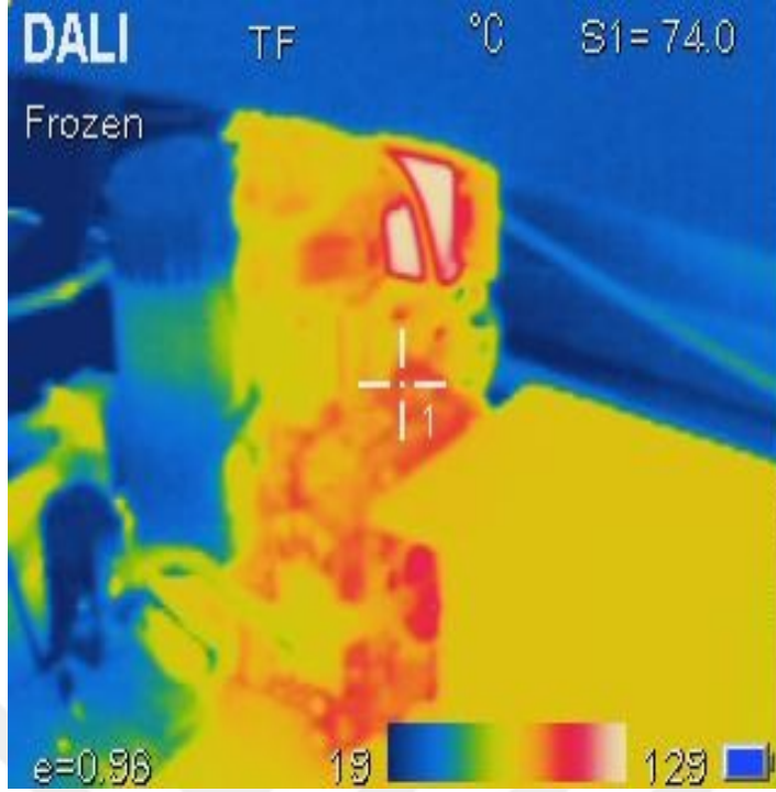
Şekil 6.35. Kaplanmış dizel motorda %20 çitlembik yakıtının kullanıldığı termal görüntü
