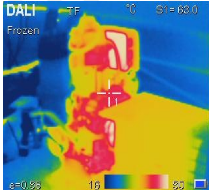
Şekil 6.40. Normal dizel motorda %50 çitlembik yakıtının kullanıldığı deneyin termal görüntüsü
