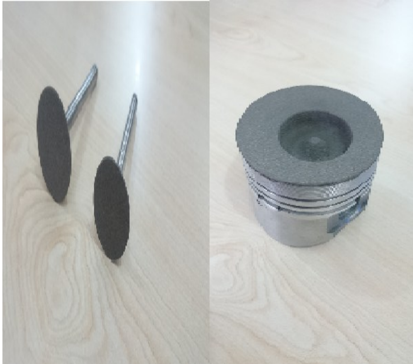
Şekil 5.7. Benzinli motorun kaplama yapılmış piston ve supaplarının görünümü.
