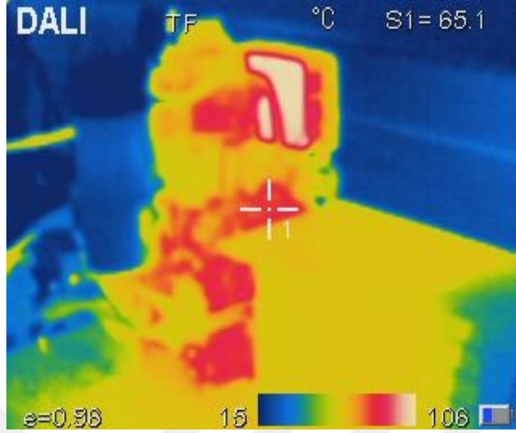
Şekil 6.39. Normal dizel motorda %20 çitlembik yakıtının kullanıldığı deneyin termal görüntüsü
