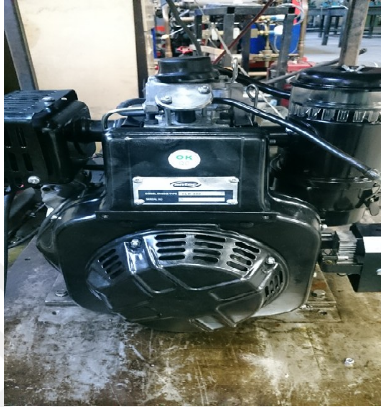
Şekil 5.1. 6LD 400 model Antor marka dizel motor
