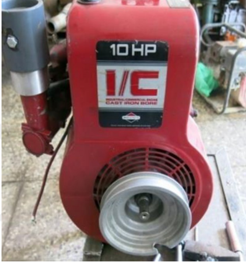
Şekil 5.2. Briggs&Stratton I/C Cast Iron 10 HP benzinli motor görüntüsü
