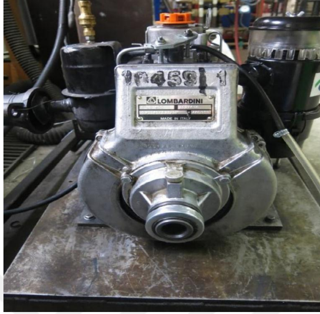
Şekil 5.1. Lombardini marka 6LD 400 model dizel motor
