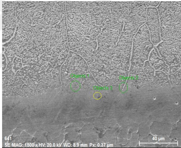
Şekil 3.22. S3 numunesinin geçiş bölgesi EDS analiz noktalarını gösteren SEM fotoğrafı
