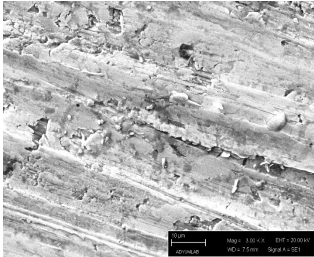
Şekil 3.50. Aşınma sonrası S2 numunesinin SEM fotoğrafı
