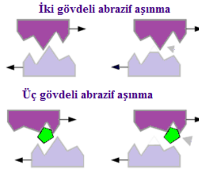
Şekil 1.9. İki ve üç gövdeli abrazif aşınma [47]
