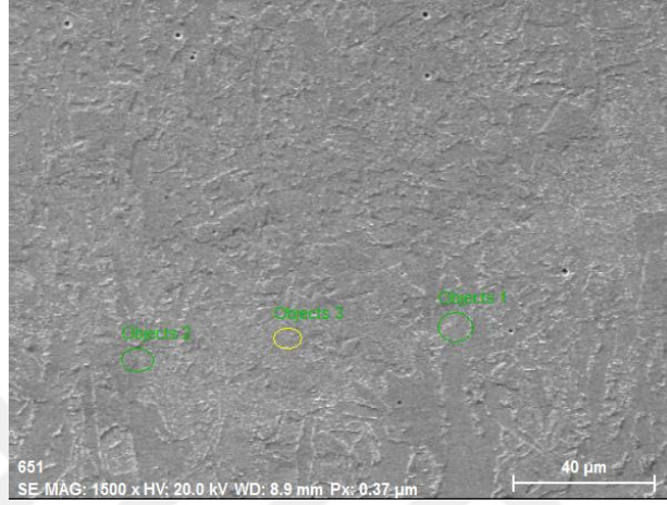
Şekil 3.4. S-Referans numunesinin geçiş bölgesi EDS analiz noktalarını gösteren SEM fotoğrafı
