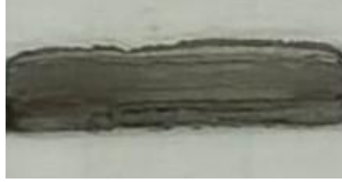
Şekil 4.1 AgNPs ve 1,6 \mu\text{m} 'lik lateks karışımının yürütme sonrası oluşan nanoyüzey fotoğrafı.
