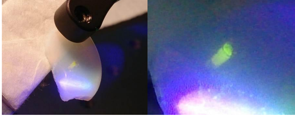
Şekil 5.2 : Mavi ışık ile aydınlatılan mikro-akışkan kanalın içinden yayılan sarı ışık.
