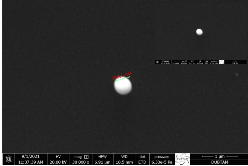
Şekil 4.29 PLD tarafından 24 dakika (14400 lazer darbesi) üretilen Ag NP'nin SEM görüntüsü
