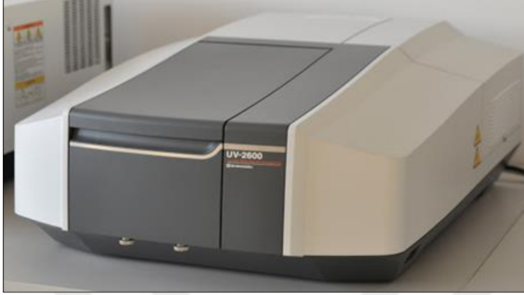
Resim 3.2. Shimadzu Uv-vis-near-IR spektrofotometre cihazı
