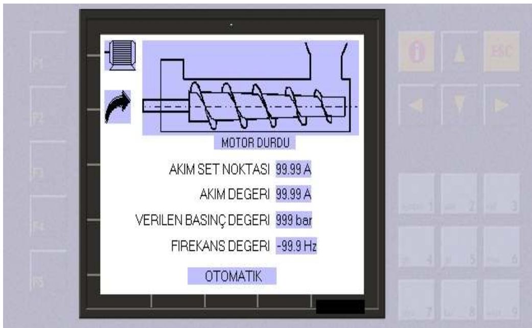
Resim 6.13. Sistemde kullanılan dokunmatik kontrol paneli
