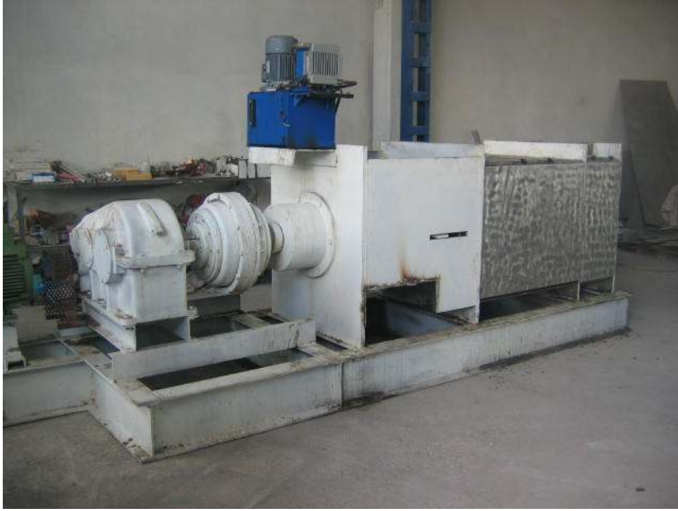
Resim 6.2. Vidalı susuzlandırma presinin arkadan görünüşü
