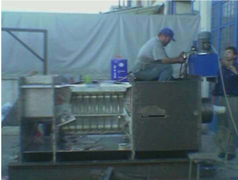
Resim 6.4. Vidalı susuzlandırma presî gövde imalatı
