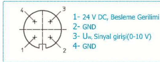
Şekil 4.20. Festo marka pnömatik oransal akış kontrol valfinin elektrik soketi bağlantı uçları ve görevleri
