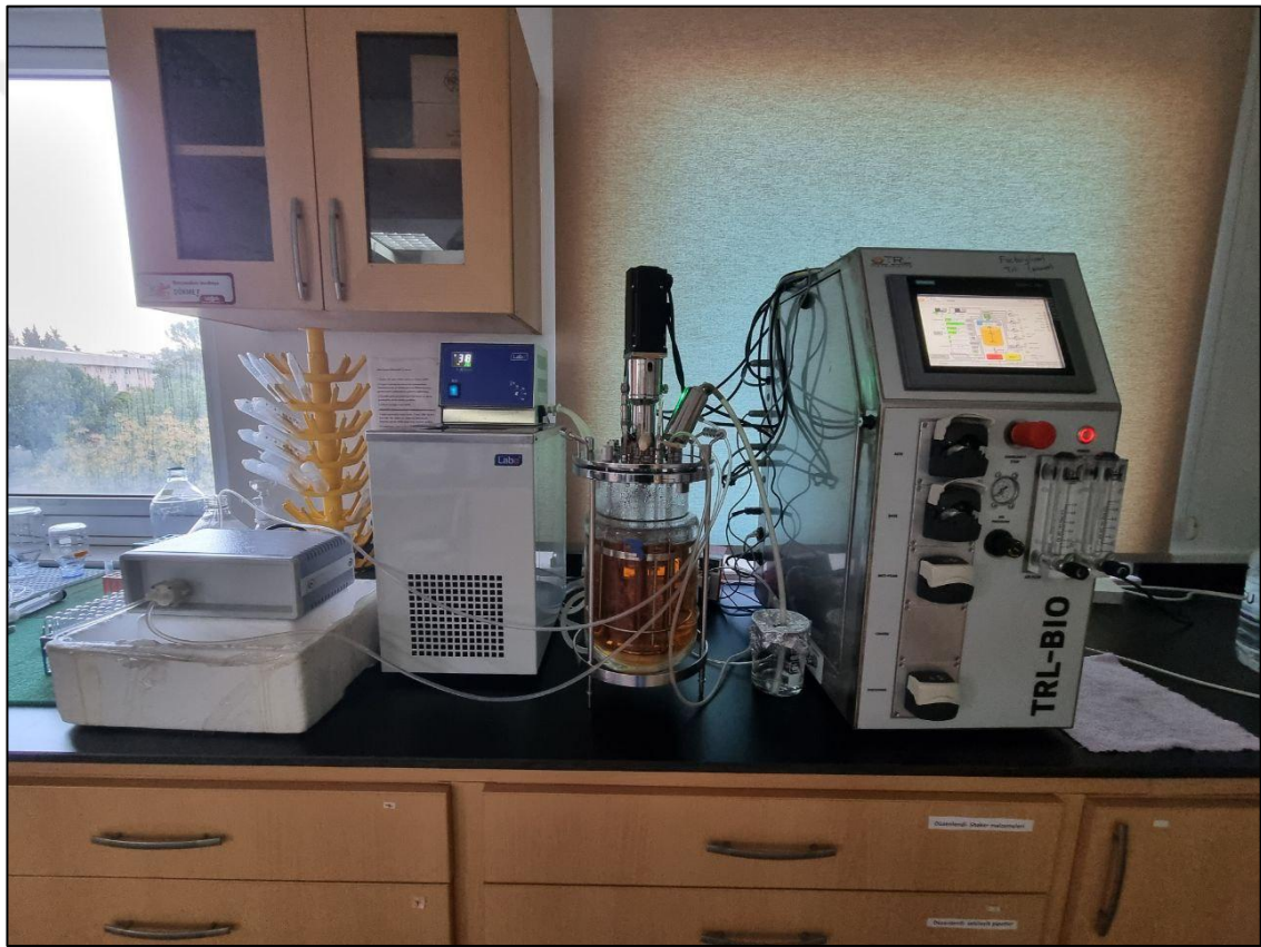
Şekil 3.1. Pleurotus ostreatus EBK13 biyokütlesi üretiminde kullanılan biyoreaktör (Trl-Bio) 1
