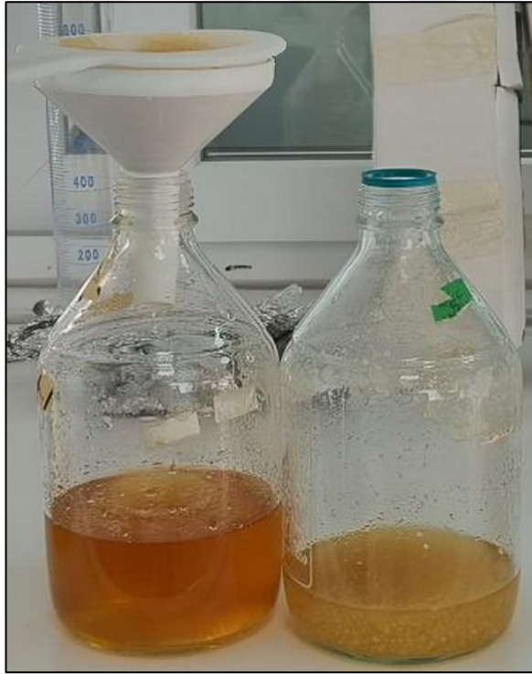
Şekil 3.4. Kabarcık sütunu fermentasyon sisteminde üretilen biyokütlenin süzölme işlemi
