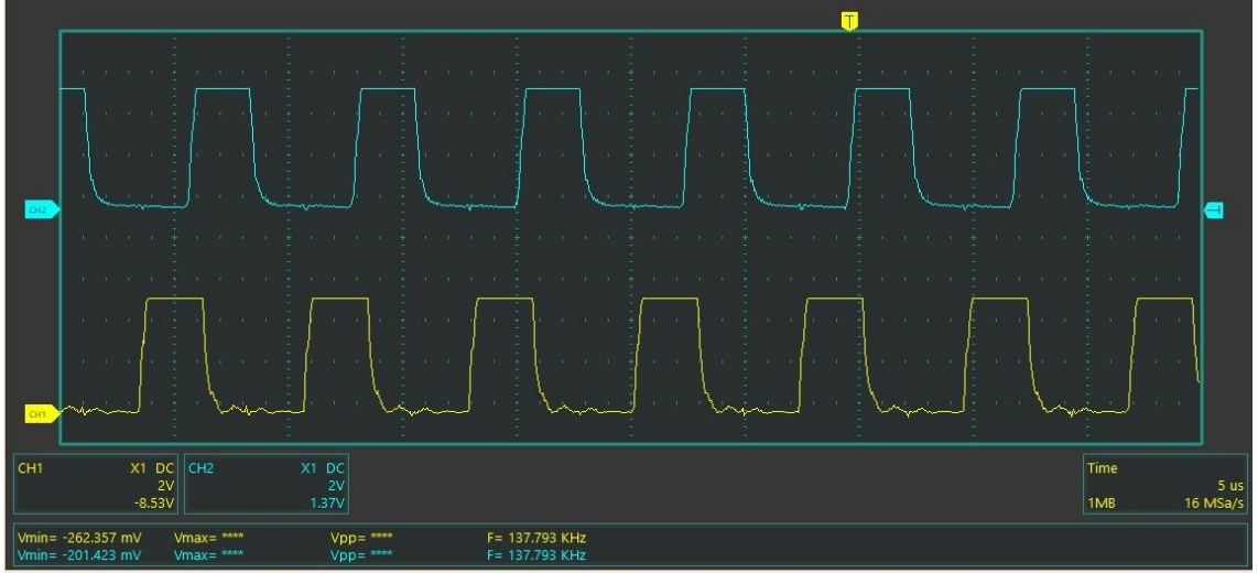
Şekil 4.19. Q1 MOSFET V gs gerilimleri
