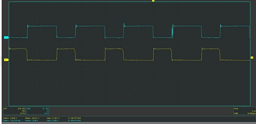
Şekil 4.17. Bobin 1 ve bobin 2 kontrol sinyallerinin TC4046 ve TC4047 entegrelerine uygulanmasıyla oluşan çıkış sinyali.
