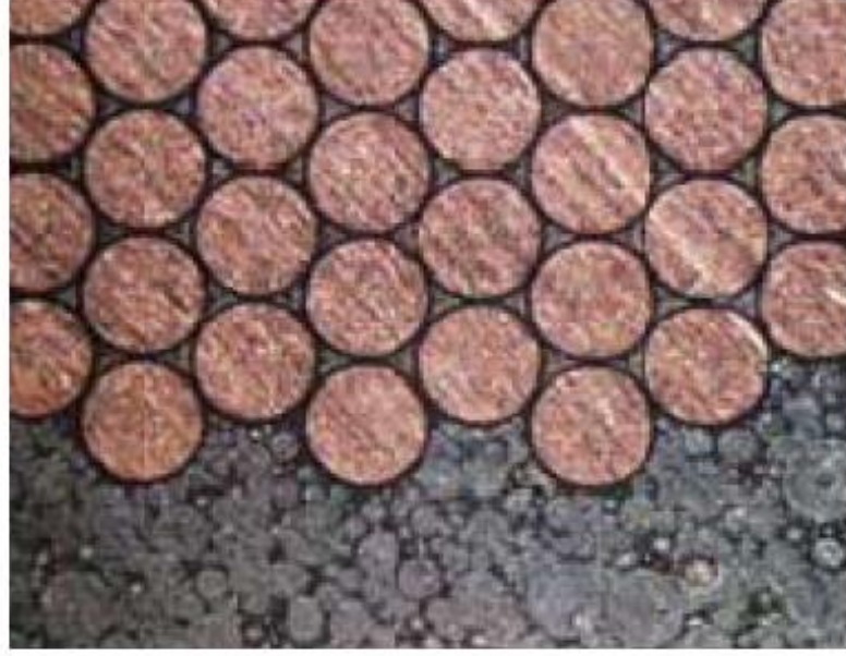
Şekil 2.13. SM 2 C ile litz teli arasında oluşturulan termal kuplaj (Frogner, 2014).
