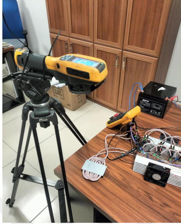
Şekil 3.18. Termal kamera ölçüm düzeneği.
