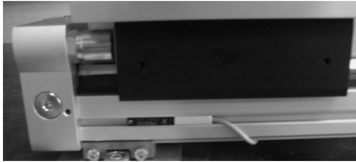
Şekil 6.15 Konum algılayıcısının milsiz DGC silindire takılmış olarak gösterimi
