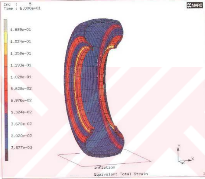
Şekil 46. Şişirme basıncı (2 Bar) etkisinde tekerde oluşan eşdeğer şekil değiştirmenin dağılımı (Model 2)
