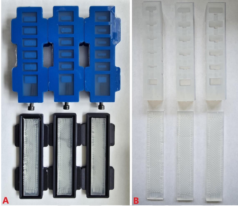
Şekil 2.57. Kalıptan ayırma işlemi: A) Kalıplarda kürlenmiş parçalar, B) Kalıplardan çıkartılmış parçalar.
