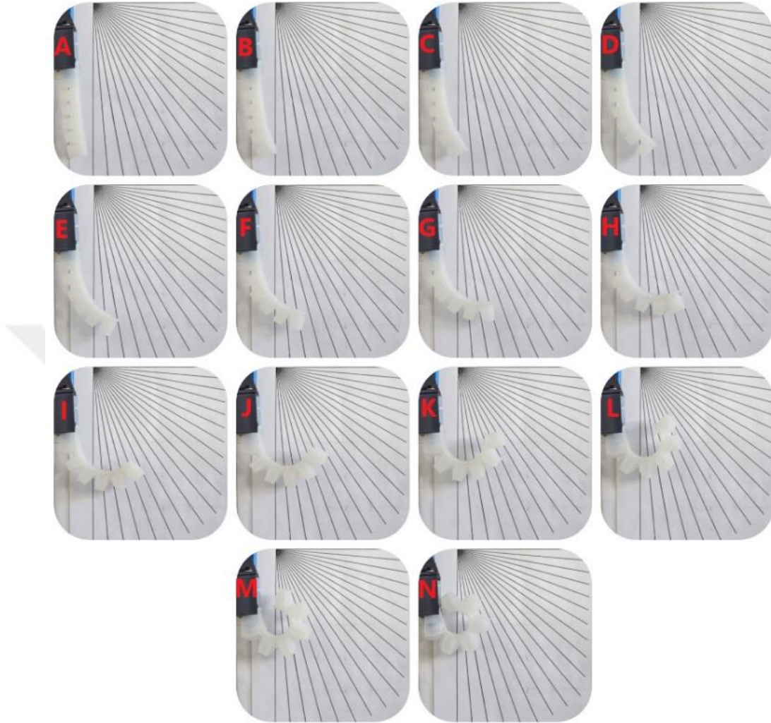
Şekil 2.70. t = 4 mm duvar kalınlığına sahip parmağın eğilme performansı deney sonuçları: A) 0 bar, B) 0,1 bar, C) 0,2 bar, D) 0,3 bar, E) 0,4 bar, F) 0,5 bar, G) 0,6 bar, H) 0,7 bar, I) 0,8 bar, J) 0,9 bar, K) 1,0 bar, L) 1,1 bar, M) 1,2 bar, N) 1,3 bar.
