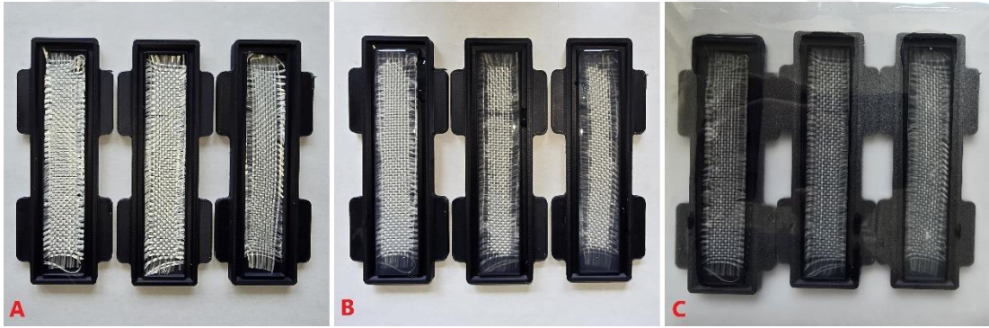
Şekil 2.56. Alt taban üretimi: A) Alt taban kalıbına cam elyaf şeridi yerleştirilmesi, B) Alt taban kalıbına sıvı silikon dökülmesi, C) Kalıpların üzerine asetat kâğıdı serilmesi.
