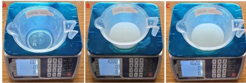
Şekil 2.24. Karışım oranının ayarlanması: A) Darası alınmış kap, B) Ham silikon, C) Ham silikon ve katalizör karışımı.
