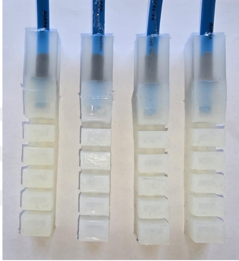
řekil 2.62. Konnekt r kalıbından  ıkan par alar.
