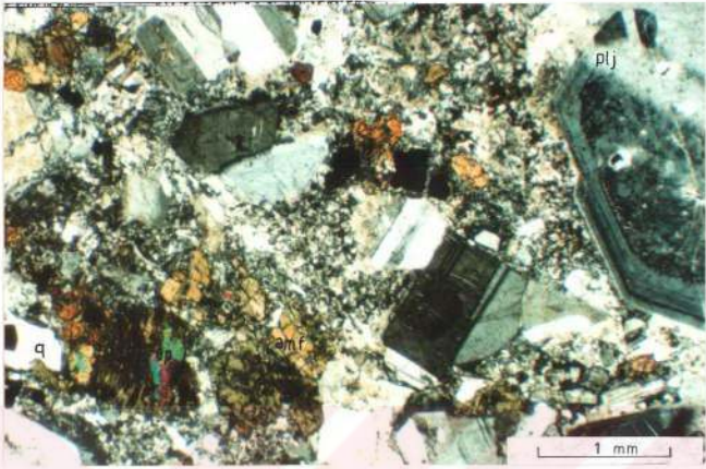
Şekil 3.20. Kuvars diyoritporfirlerdeki felsöfrik doku ve fenokristallerin genel görünümü (Örnek No: 58). plj: plajiyoklaz, amf: amfibol, q: kuvars, ep: epidot; Ç.N.X32.
