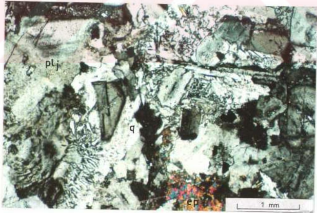
Şekil 3.13. Tonalit grubu kayalarda sıkça izlenen granofirik dokunun mikroskopta görüntüsü (Örnek No: 86). plj: plajiyoklaz, q: kuvars, ep: epidot; Ç.N.X32.
